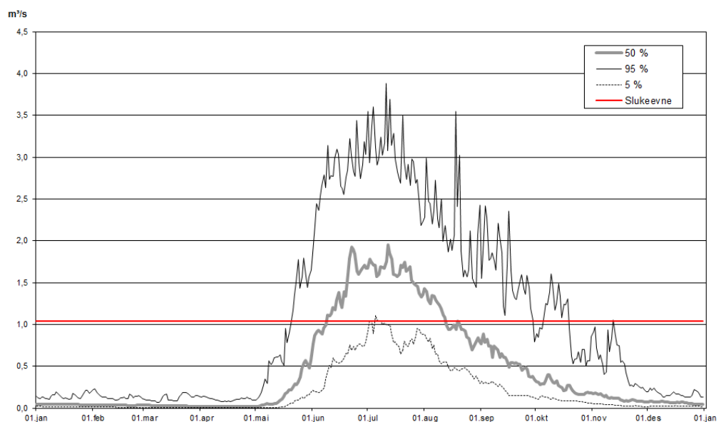
Figur 5: Persentiler over året med angitt optimal slukeevne
