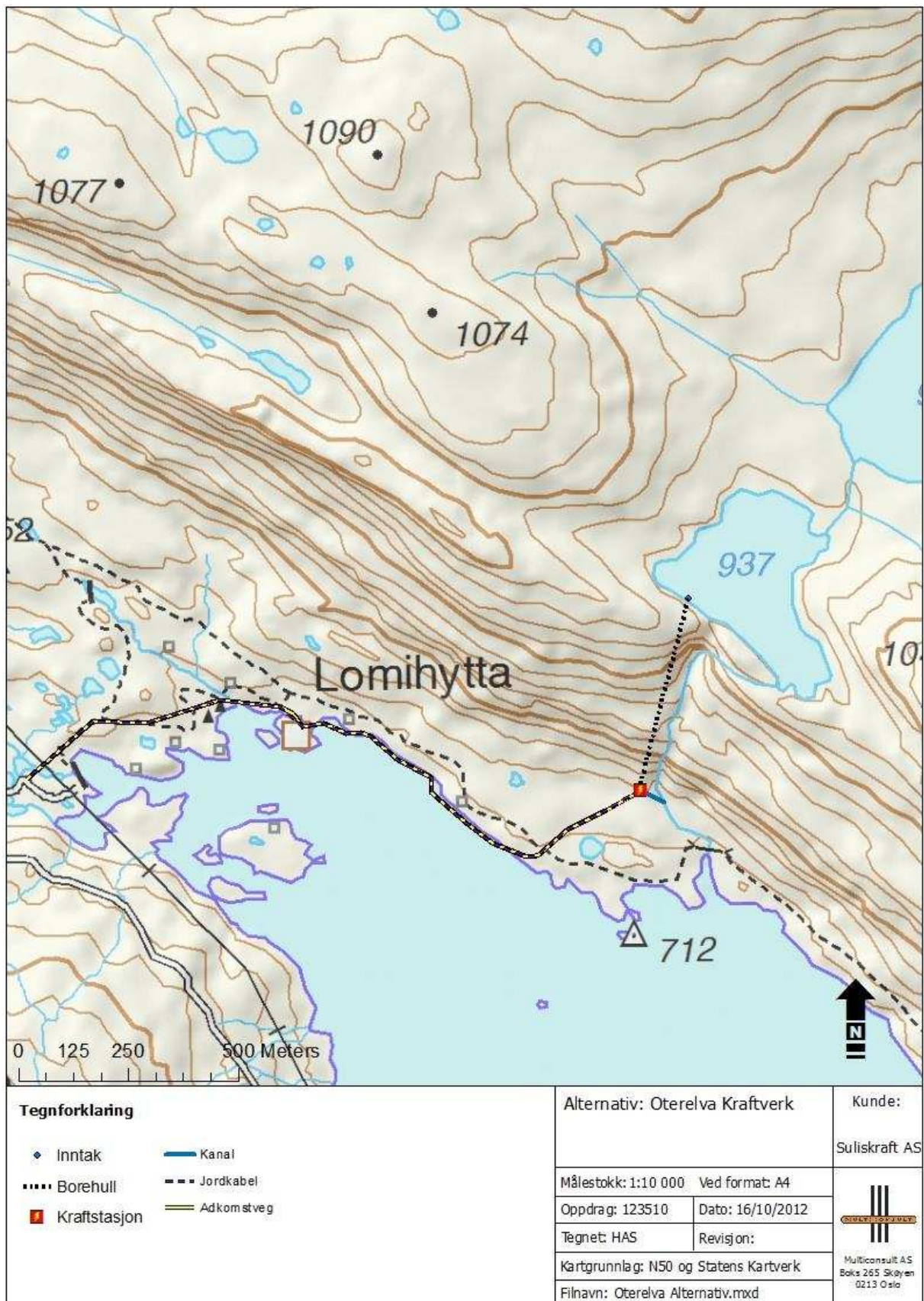
Figur 3. Alternativ utbyggingsløsning for Oterelva kraftverk.
