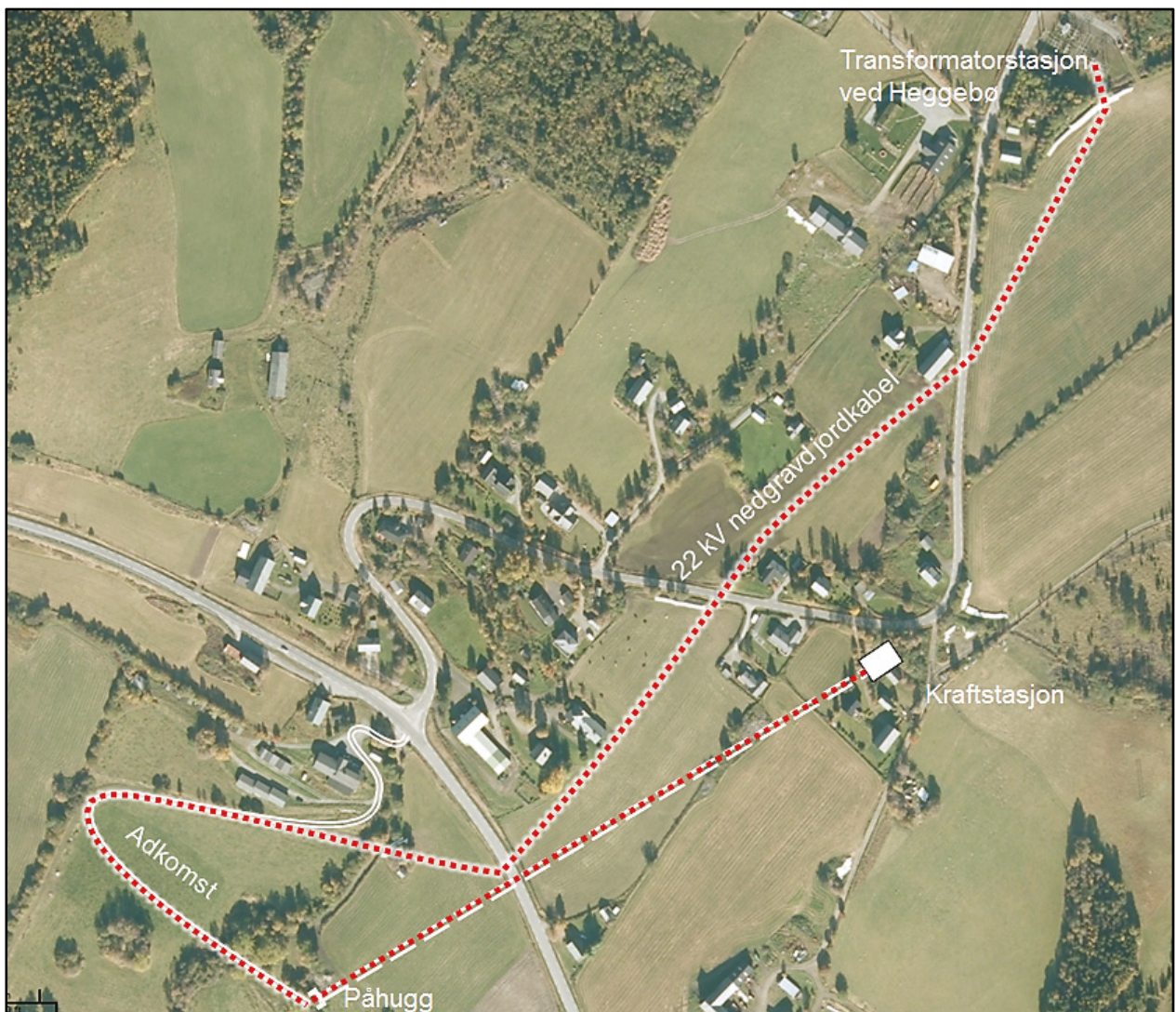
Figur 5-15 Planlagt trasé for 22 kV jordkabel, alternativ 1
