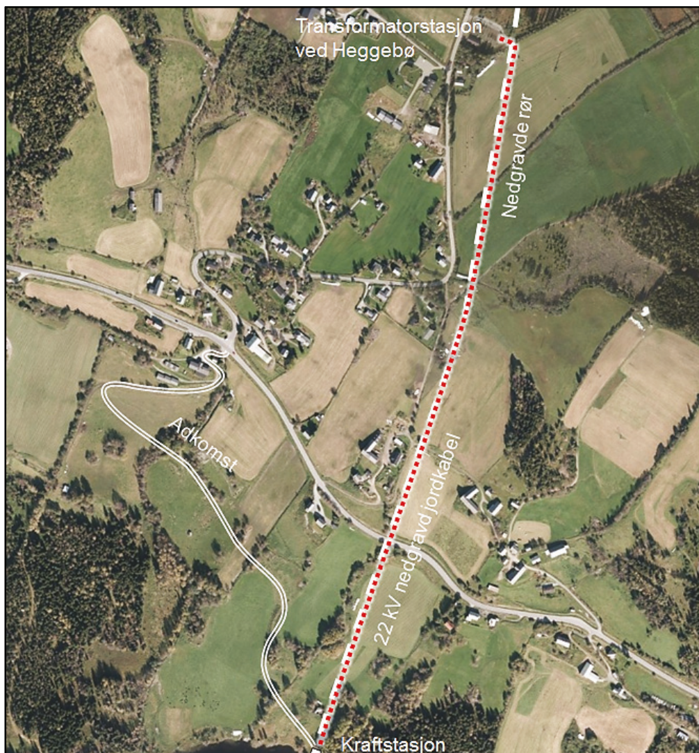
Figur 5-16 Planlagt trasé for 22 kV jordkabel, alternativ 2
