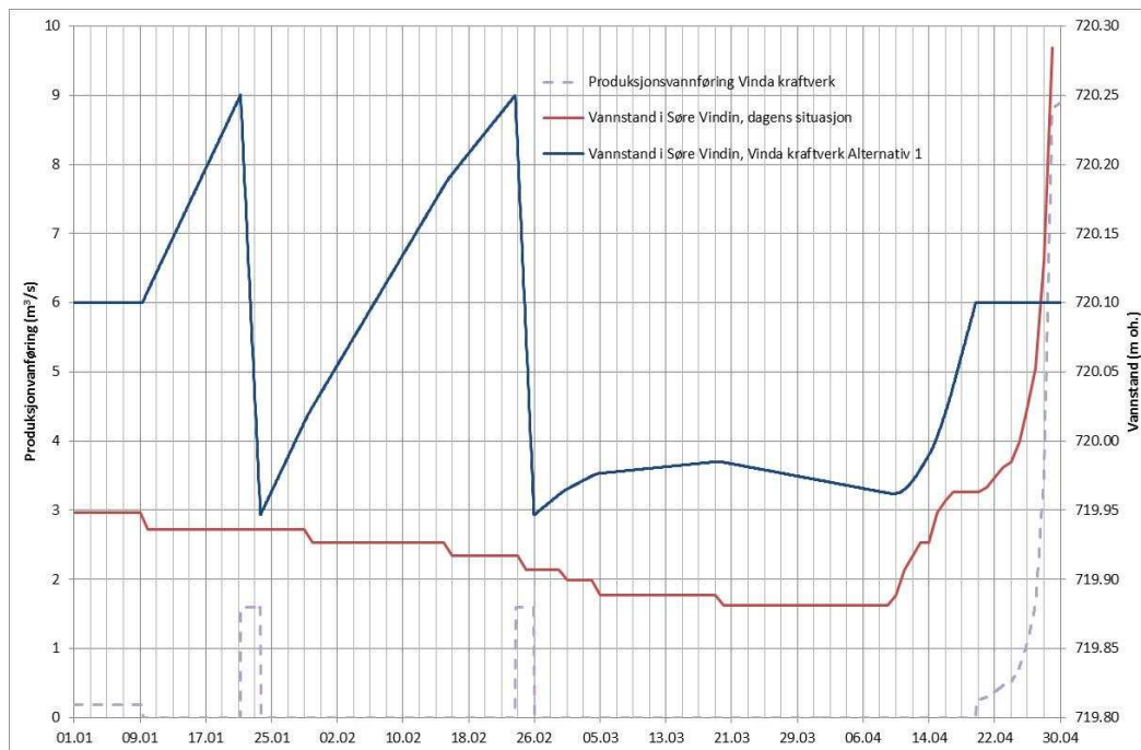
Figur 4-8 Eksempel på vannstandsvariasjon i en periode (januar til april 1984) hvor tilsig til Søre Vindin fratrukket minstevannføring er mindre enn minste slukeevne til Vinda kraftverk (Alternativ 1)
