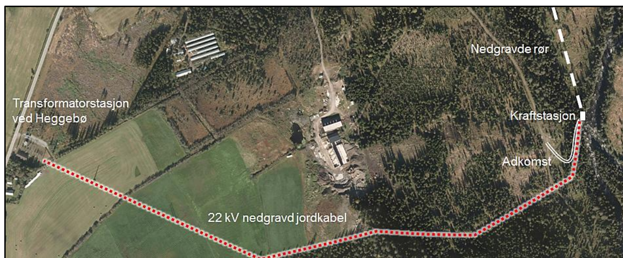
Figur 3 Planlagt trasé for 22 kV jordkabel, alternativ 3
