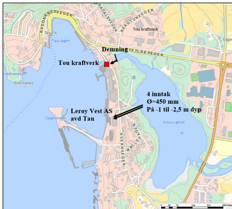
Figur 2. Krossvatnet med Tou kraftverk og Lerøy Vest AS avd. Tau på sørsiden av det ene utløpet til Tauelva, med de fire inntakene i Krossvatnet.
