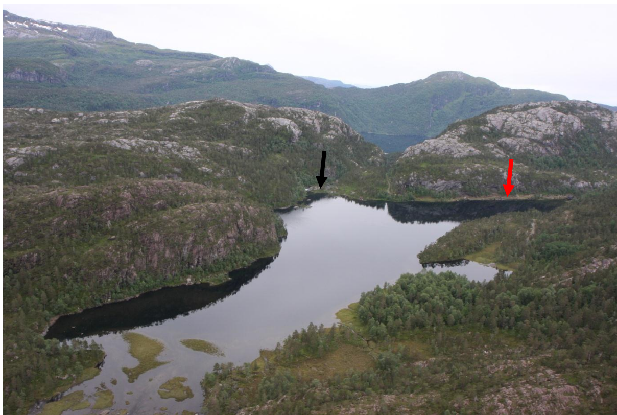
Bilete 1 Oversiktsbilete over Litlevatnet. Nede til venstre i biletet er innløpet av Hestedalselva. Inntaksområdet er markert med ei raud pil og utløpet/ damplassering med ei svart pil. Biletet er teke frå helikopter over utløpet av Hestedalselva i Litlevatnet.
