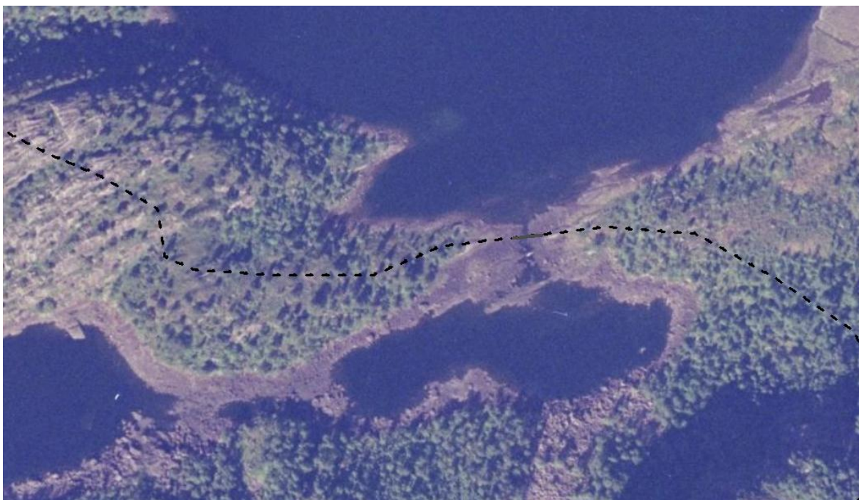
Bilete 5 Flybilete som viser Symjinga ved låg vasstand. Den stipla line markerer vasskillet. Den gra lina markerer planlagd dam.
