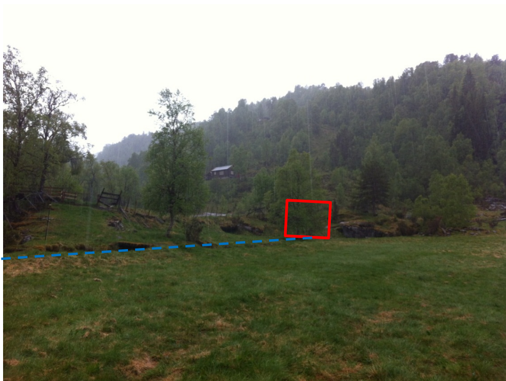
Figur 5 - 14: Bilete sett mot sør. Plassering av kraftstasjon skissert med firkant. Blå stipla line indikerer avlaup for produksjonsvatn frå kraftstasjon langs eksisterande bekkefar som må utbetrast. Foto: Ole Reidar Flatby
