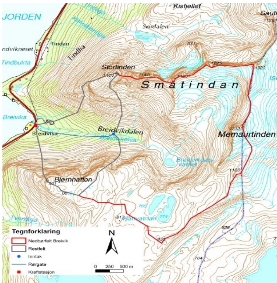
Figur 3. Oversiktskart Breivikelva kraftverk (fra konsesjonssøknad).
