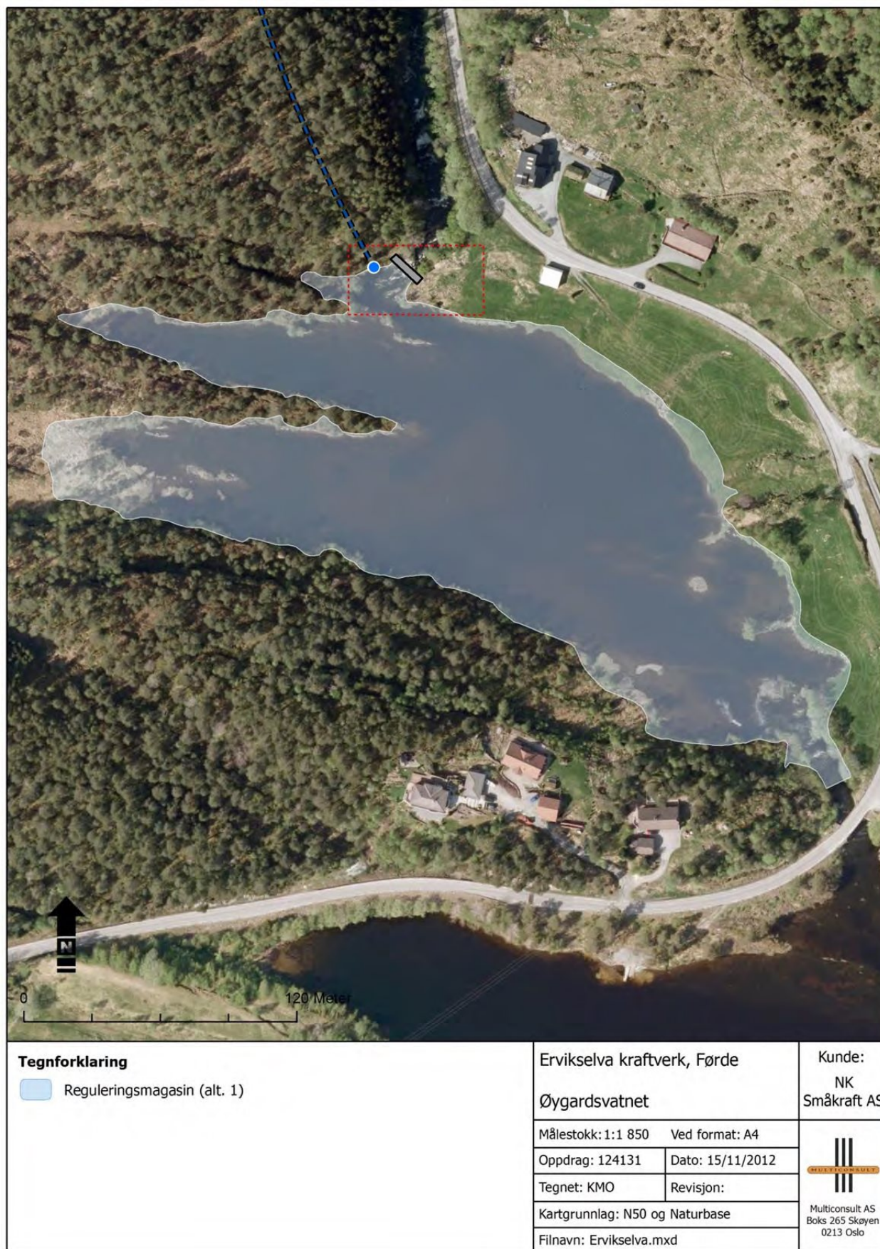
Figur 24. Oversikt over forventet størrelse på reguleringsmagasinet ved en heving av vannstanden på 0,9 m. Magasinet er avgrenset på bakgrunn av 1 m koter for området.
