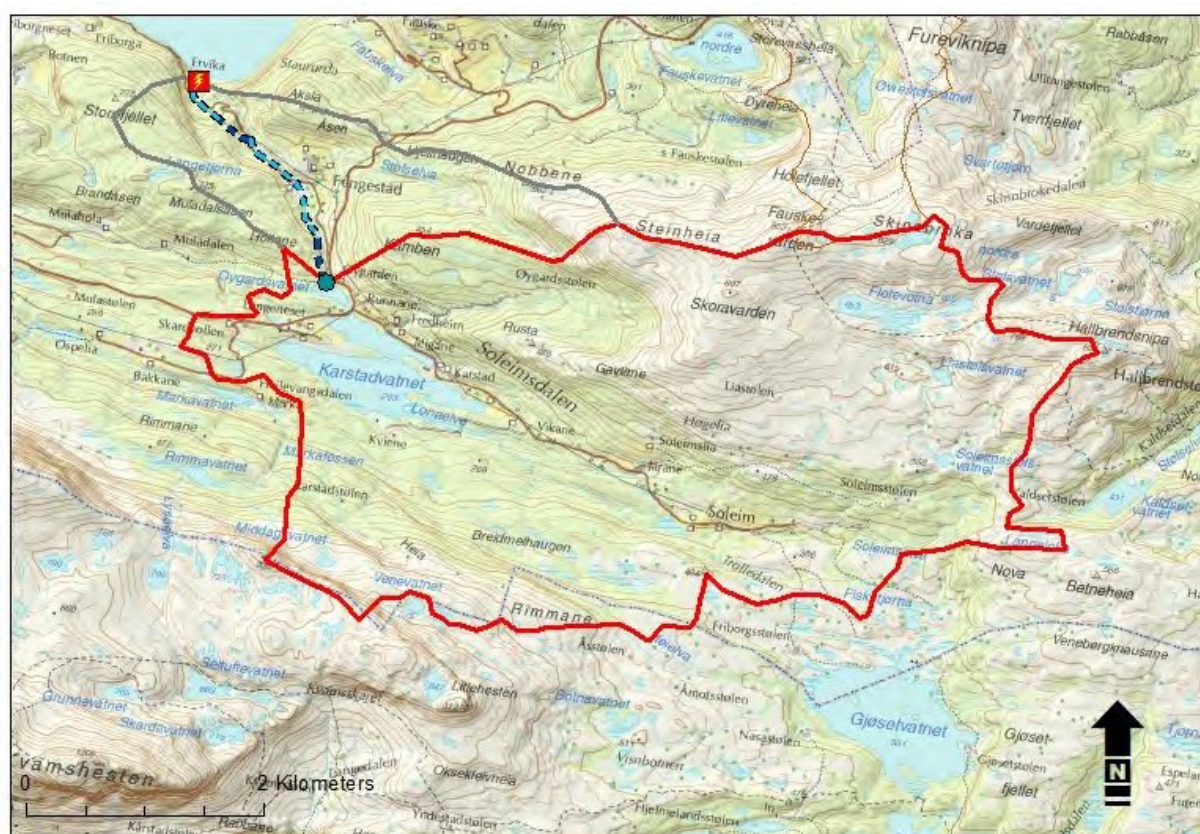
Figur 4. Nedbørsfelt (rødt) og restfelt (grått) for kraftverket.
