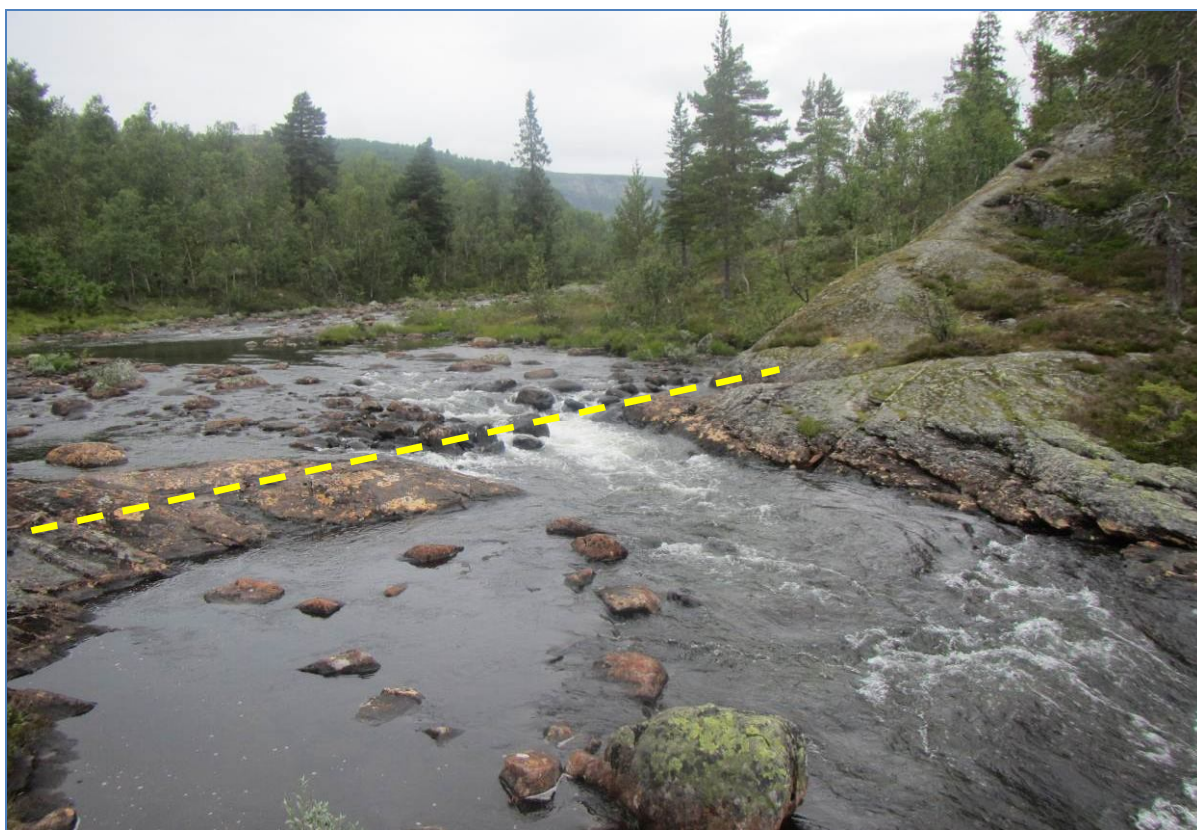
Figur 7. Inntaksdammen plasseres med damakse som vist på figuren. Bildet er tatt fra nedstrøms side.
