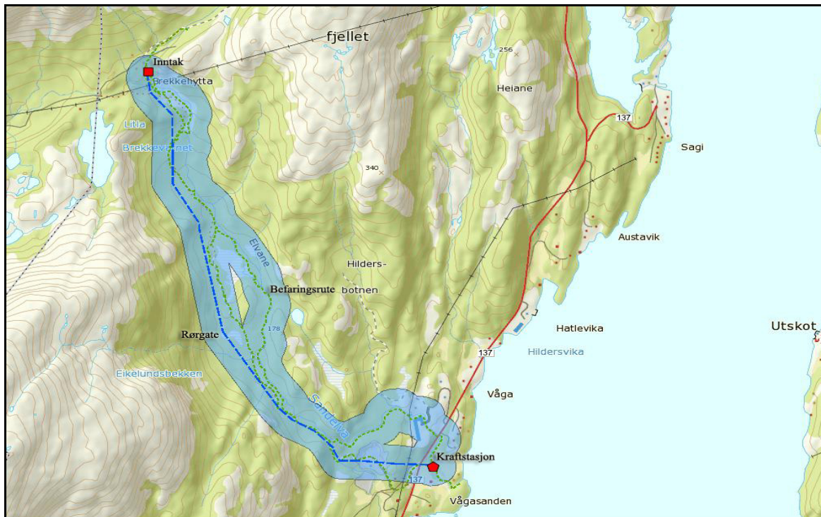
Figur 2. Kartet viser influensområdet til planlagte inngrep (blått felt), i henhold til tommelfingerregelen om at en sone på ca. 100 meter langs berørte elvestrekninger og fysiske inngrep blir berørt. Grønn stiplet linje viser befaringsruten.
