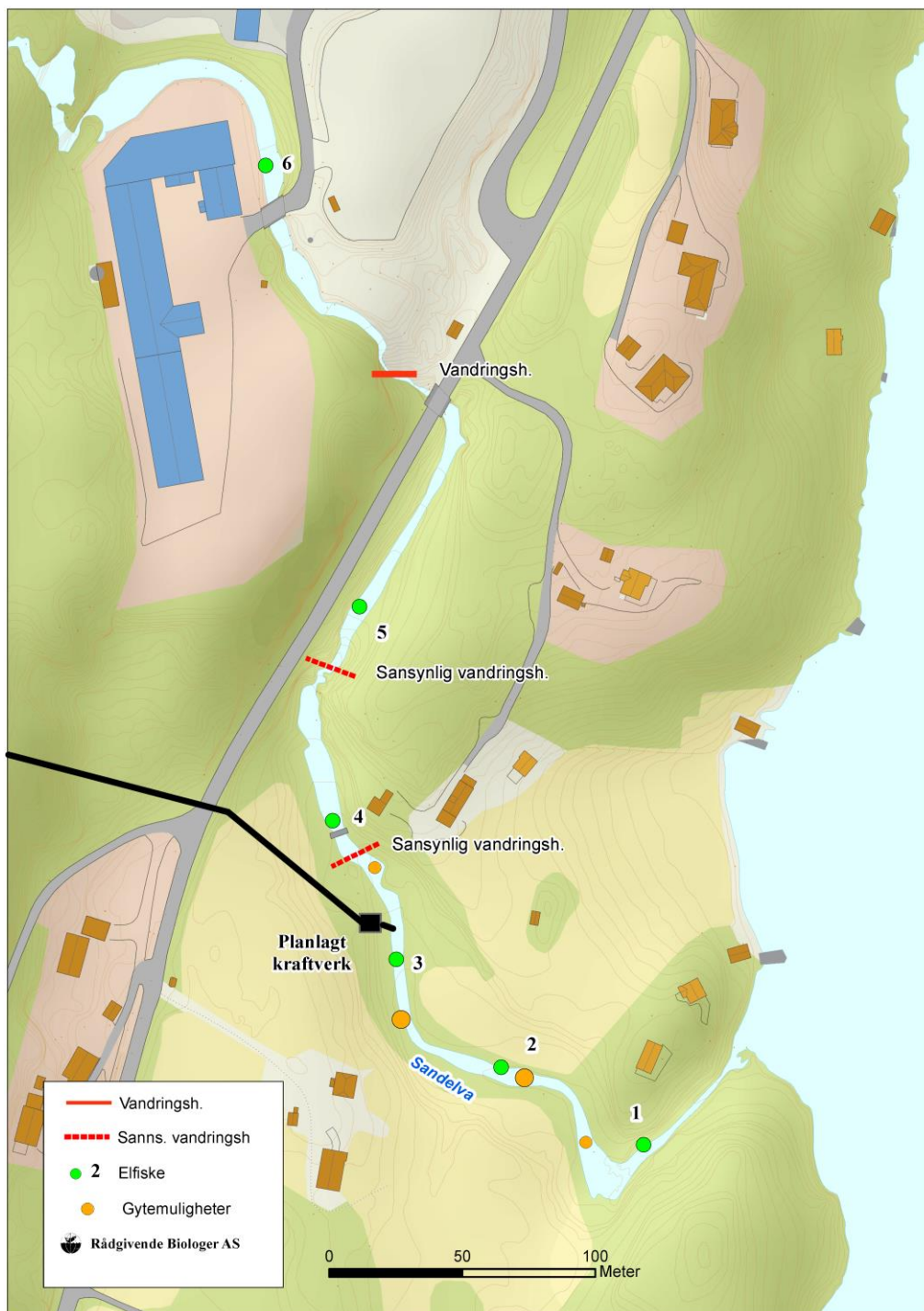
Figur 1. Nedre del av Sandelva med, med planlagt kraftstasjon. Sannsynlige og absolutt vandringshinder er markert. Områder med gytemuligheter er vist med oransje sirkler, små sirkler er svært små/usikre gyteområder. Elektrofiskestasjoner er vist med grønne prikker.
