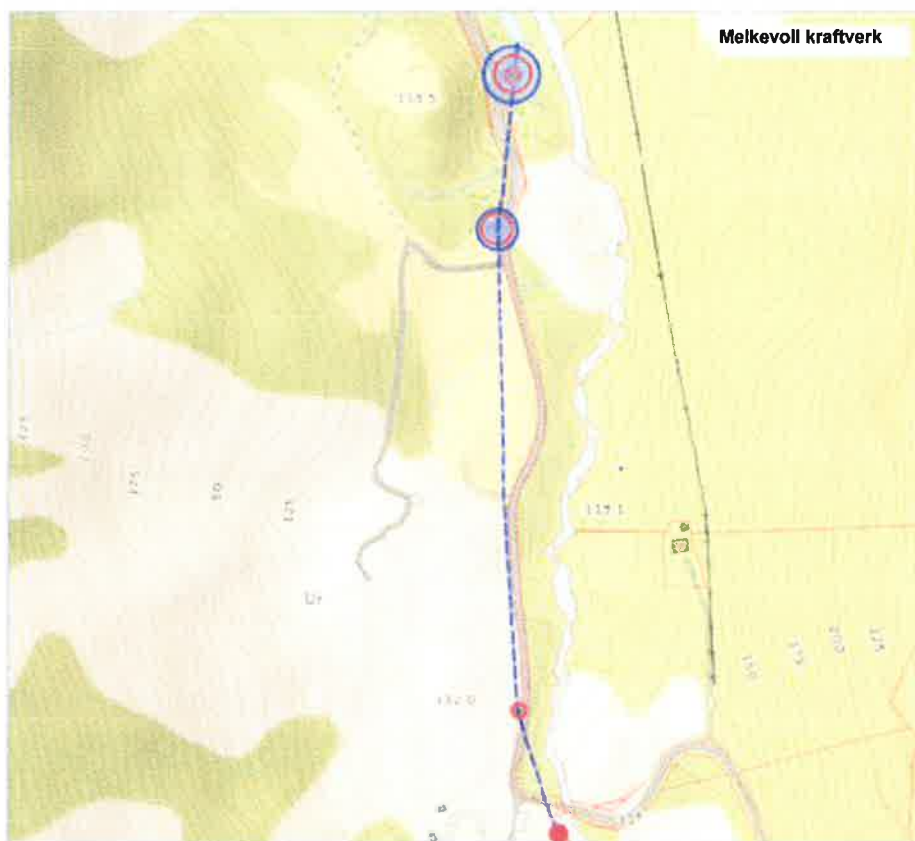
Fig. 22 Kastvidder ved røyrbrot. Blå sirkel viser kastvidder ved små hol i røyra. Raud sirkel viser kastvidder ved røyrbrot.
