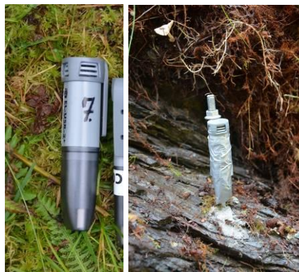
Figur 28. Enkel logger av typen EL-USB-2+ fra LascarElectronics INC for målinger av luftfuktighet, lufttemperatur og duggpunkttemperatur. Her boret fast i fjell. Foto: Per G. Ihlen.
