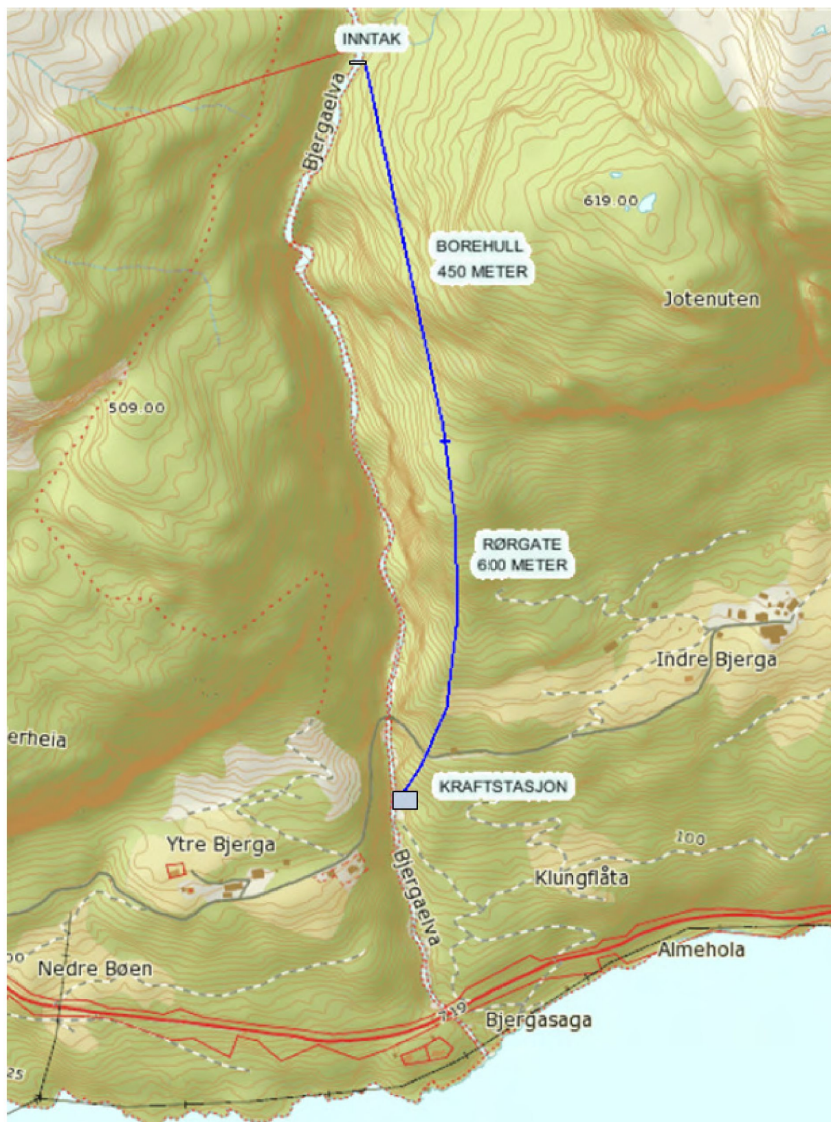
Figur 2.6: Detaljkart, vannvei fra inntak til stasjon.
