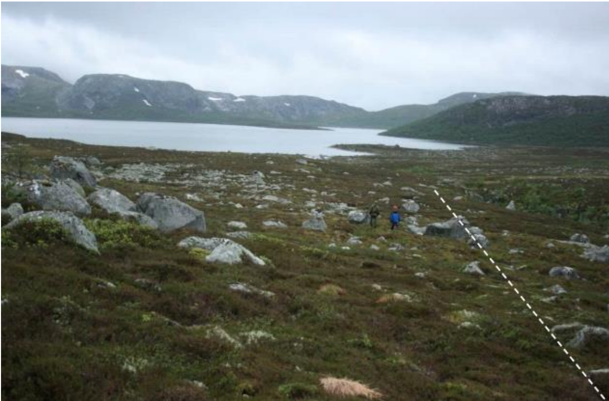
Figur 2 - Øvre del av tiltaksområdet med dam og inntak planlagt sentralt i bildet. Vannvei i boret tunell som illustrert i bildet. Bildet er hentet fra konsesjonssøknaden.
