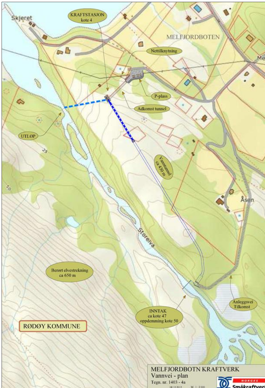
Fig. 8. Planskisse for småkraftverk i Storelva, Melfjordbotn i Rødøy kommune, Nordland. Inntaket er planlagt på kote 47 (topp av dam på kote v50) og med kraftstasjon plassert på kote 3. Kart: Tiltakshaver.
