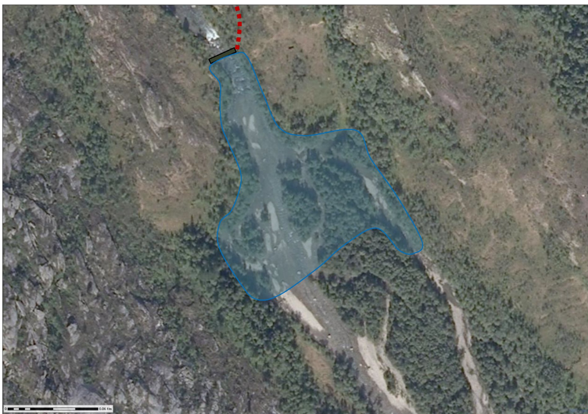
Fig. 35. Inntaket, med en ca 3 meter høy dam, vil danne et mindre elvemagasin. Ortofoto: Miljøstatus 2012.
