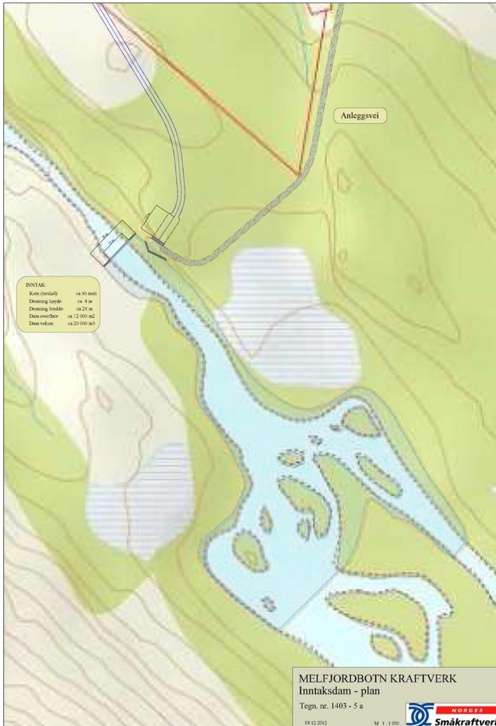
Fig. 7. Inntaksdammen plasseres der Storelva endrer karakter fra et flatere parti til mer hurtigstrømmende elv ned mot Melfjorden. Kart: Tiltakshaver.
