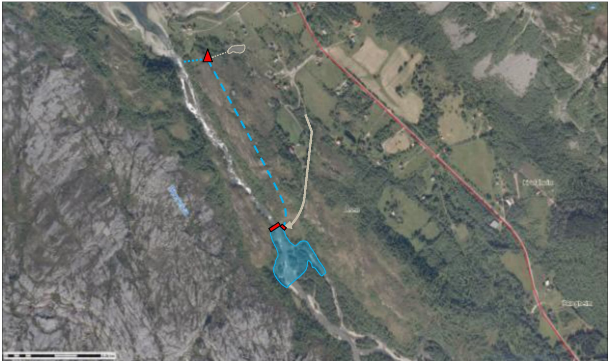
Fig. 9. Kraftanlegget som er planlagt i Storelva vil ha et mindre inntaksmagasin i elva og vannvei i tunnel ned til kraftstasjonen i fjell. Tunnel inn fra planlagt P-plass. Ny vei til inntaket fra nord. Ortofoto: Miljøstatus 2012.
