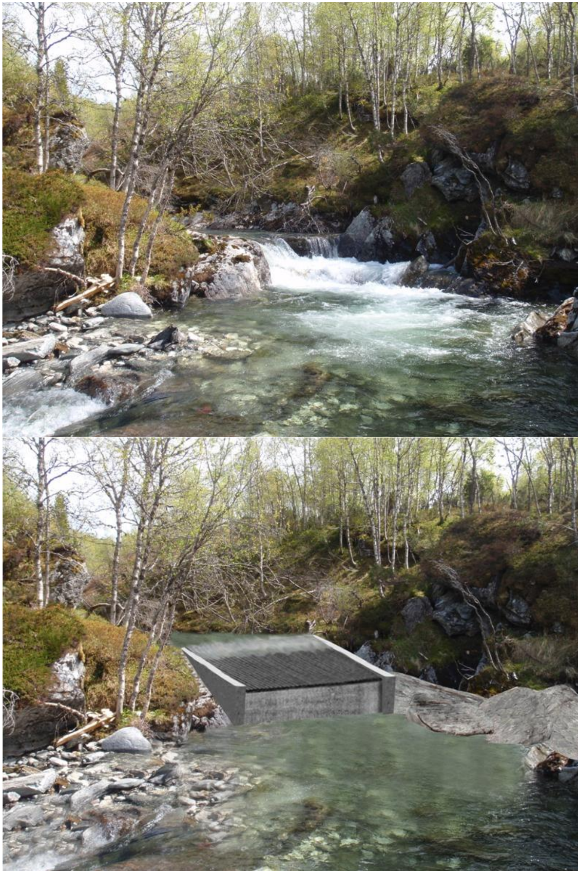
Figur 5 Visualisering av inntak i Ommedalstverrelva – før og etter utbygging
