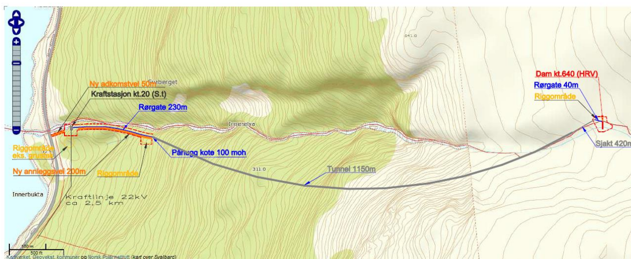
Figur 3-17: Situasjonsplan alternativ med tunnel og sjaktboring
