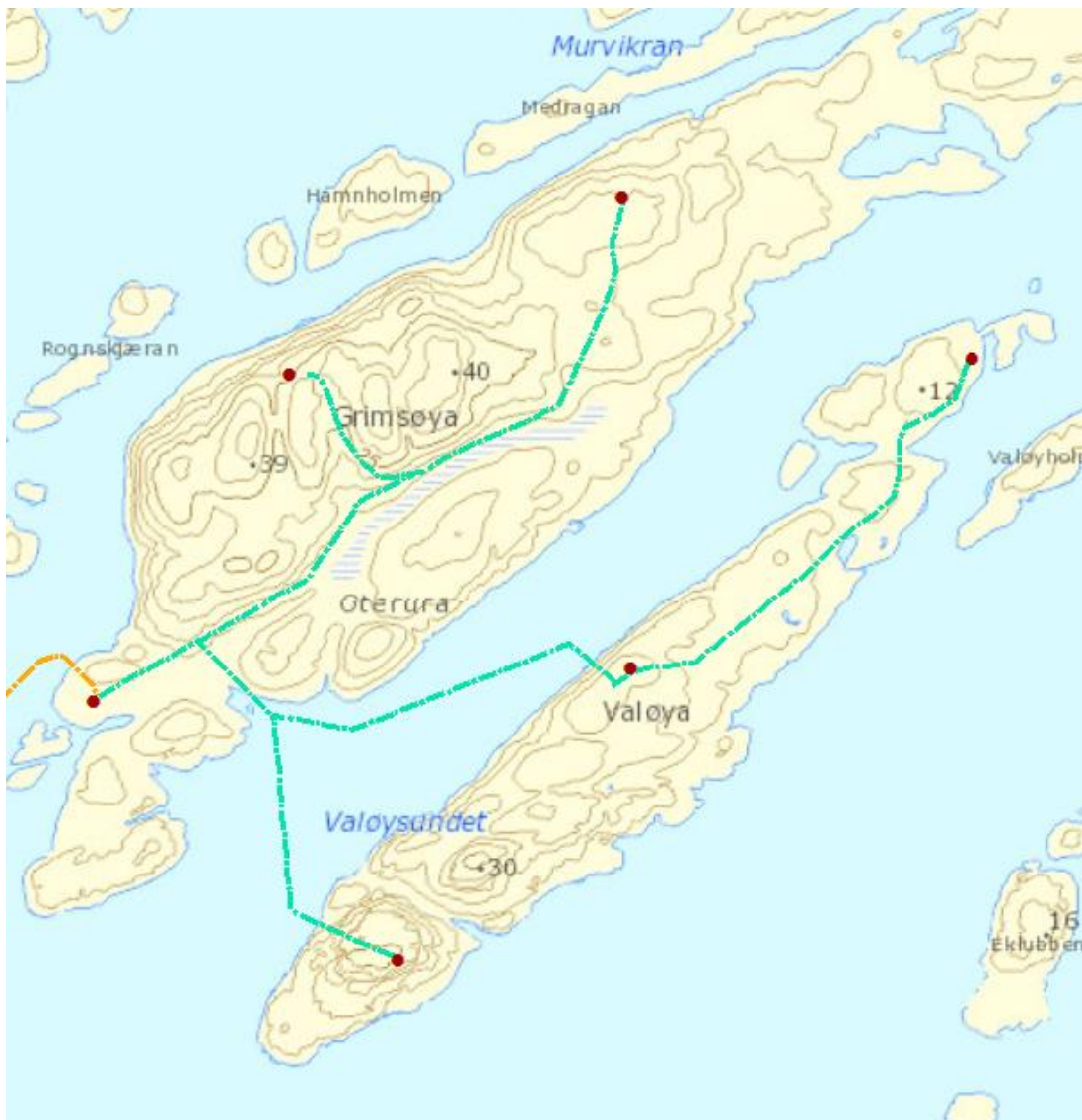
Figur 4.5. Forslag til internt kabelnett (jord- og sjøkabel).
