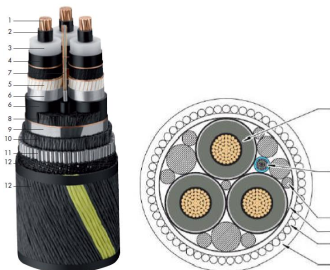
Figur 4 Typisk skjermet, PEX-isolert, treleder sjøkabel med kobberleder, integrert fiber og ståltrådarmering /6/ og /7/
