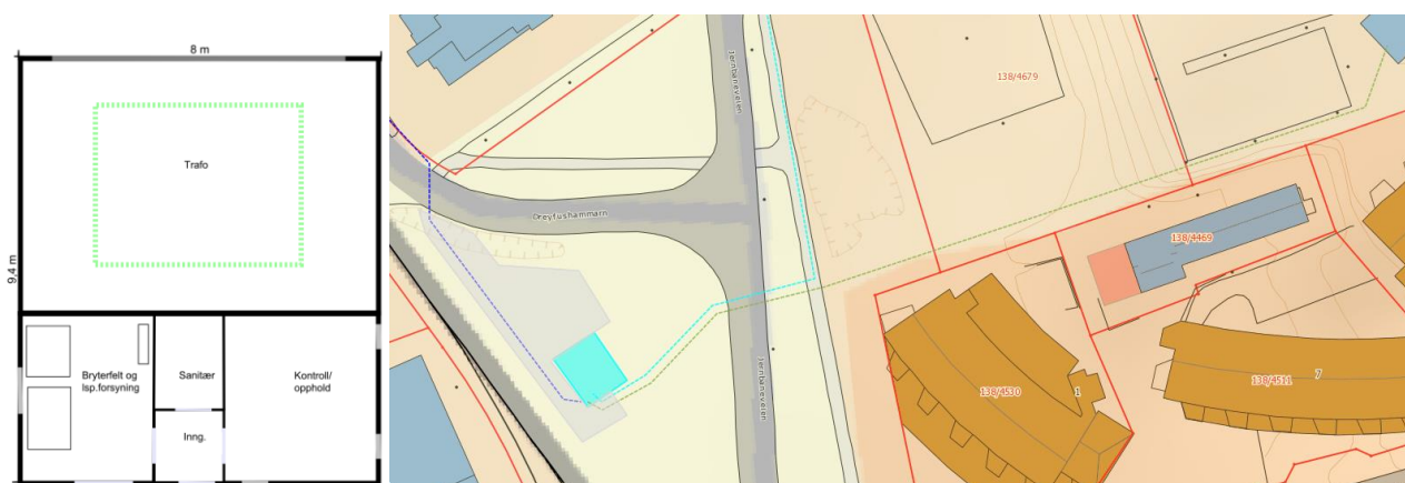
Figur 21 Eksempel på stasjonsutforming og plassering (alt.2)
