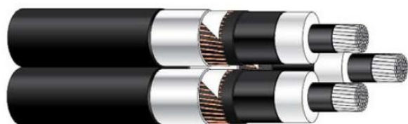
Figur 15 Typisk skjermet, PEX-isolert enleder jordkabel med aluminiumsleder forlagt i trekant /16/
