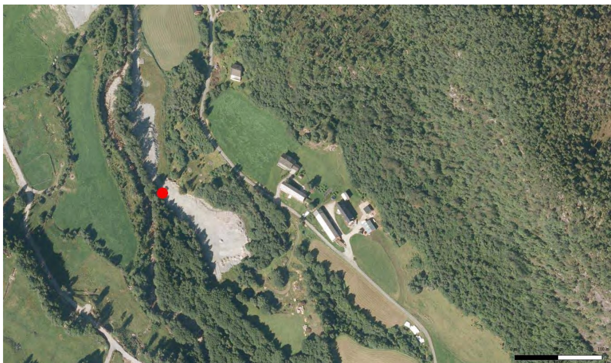
Bilde 7: Stasjon markert med rød sirkel. De grå områdene er en sprengsteinfylling tilstrekkelig for stasjonstomt. Gislink.
