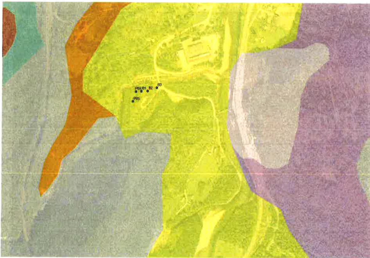
Figur 2: Viser løsmassene i området kartlagt av NGU. Gule avsetninger er elveavsetninger, oransje er breelevavsetninger. Vannverket ligger på elveavsetninger med brønnfiltrene antagelig i breelevavsetninger lenger ned i massene. Brønnene er markert med grønne sirkler.
