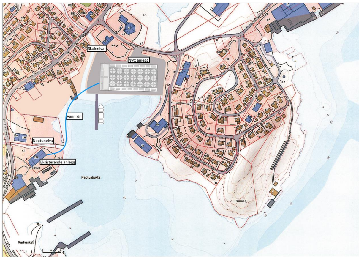
Bilde 5: Nytt vannrør fra reservevannkilde
