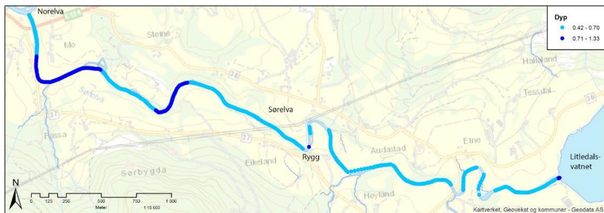
Figur 8.21. Vandndyp ved 8,5 \text{ m}^3/\text{s} i Sørrelva, beregnet i Hec-ras, på bakgrunn av 33 transekter målt opp langs hele elvas lengde. Data mangler fra lyse blå områder.
