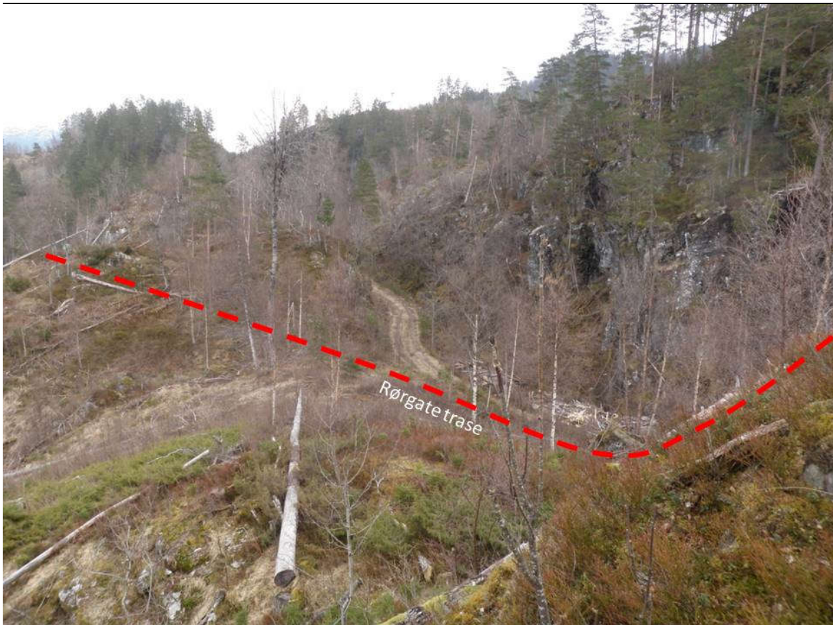
Figur 2.13 Deler av rørgatetraséen vil gå over hogstflate – gjelder begge alternativer
