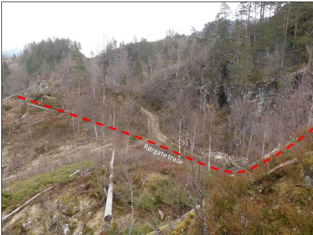
Figur 5.5: Deler av rørgatetraséen vil gå over hogstflate for begge alternativer.
