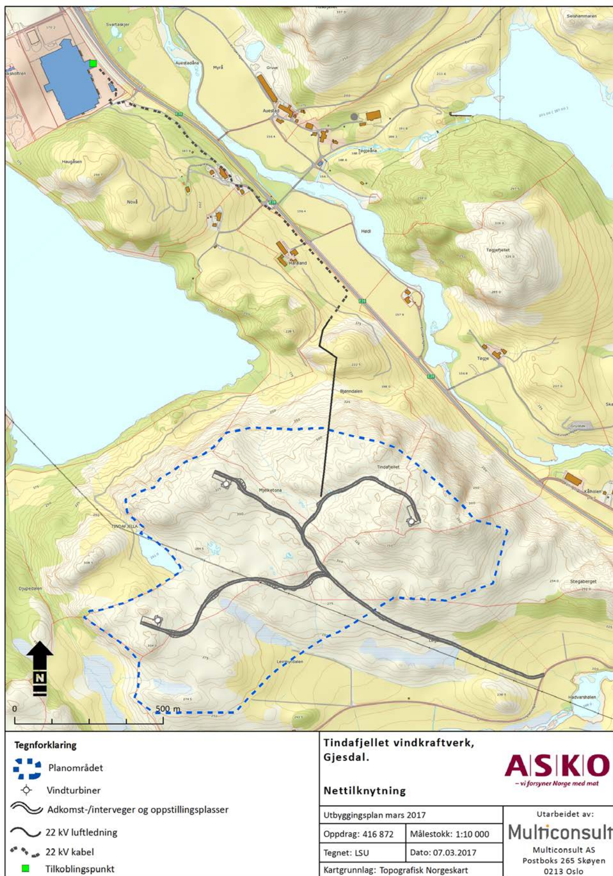
Figur 3. Nettilknytning for Tindafjellet vindkraftverk.
