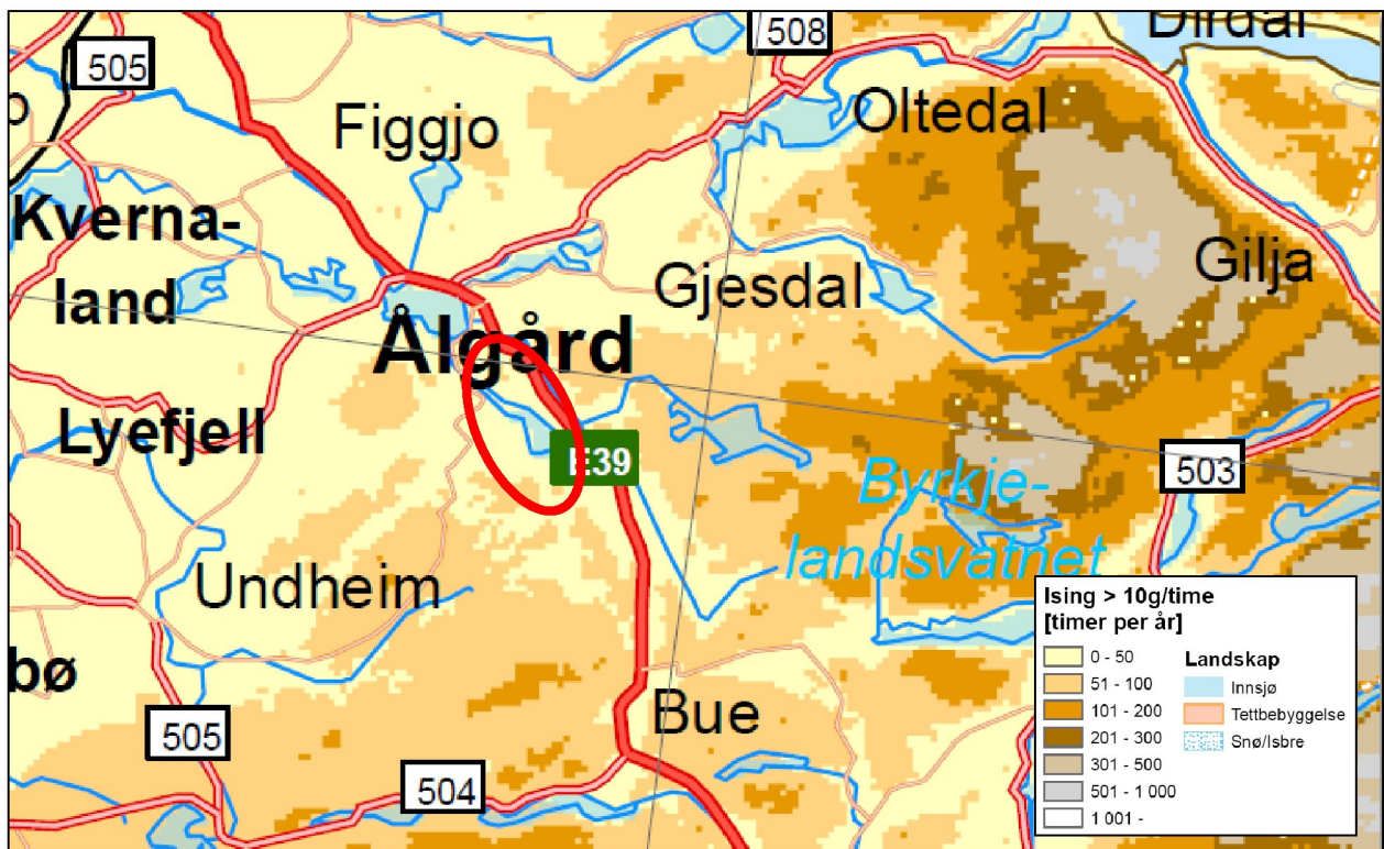
Figur 45. Forventet omfang av ising (med påfølgende risiko for iskast) i planområdet for Skurvenuten og Tindafjellet vindkraftverk. Gul farge angir 0–50 timer/år. Kilde: Byrkjedal (2009).
