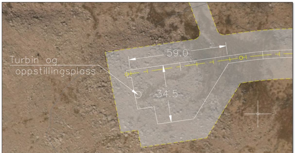
FIGUR 7: UTSNITT AV EN OPPSTILLINGSPASS
