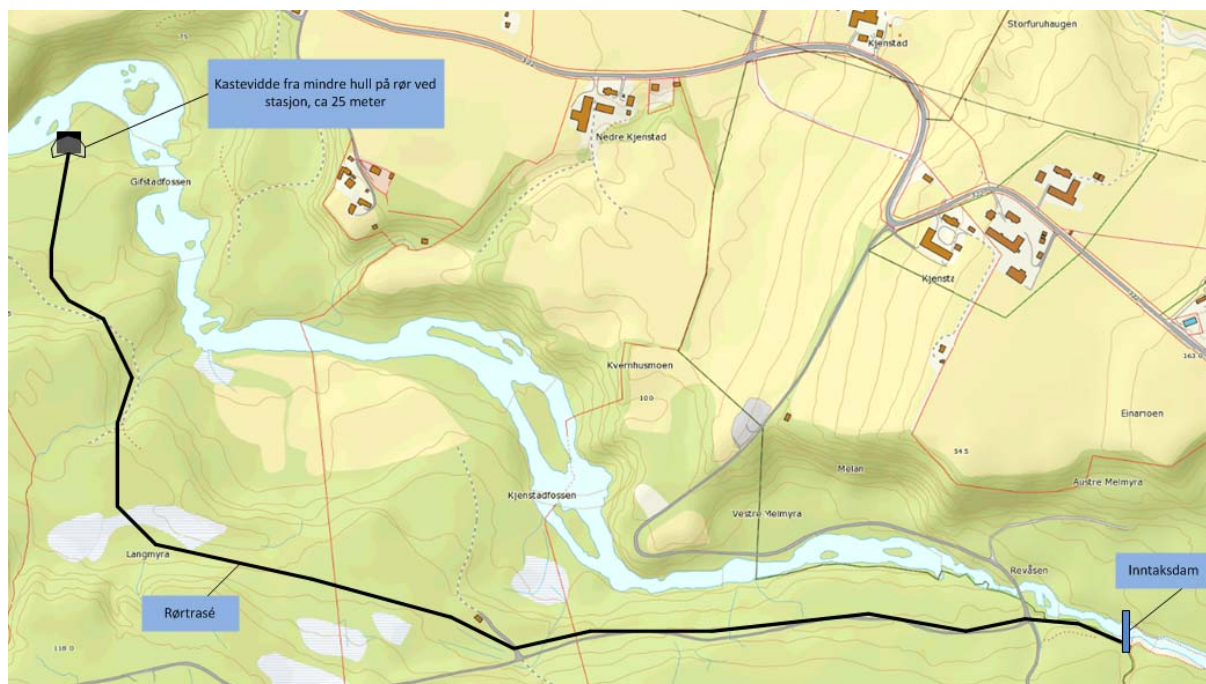
Figur 3.13: Kastevidde ved mindre rørbrudd.
