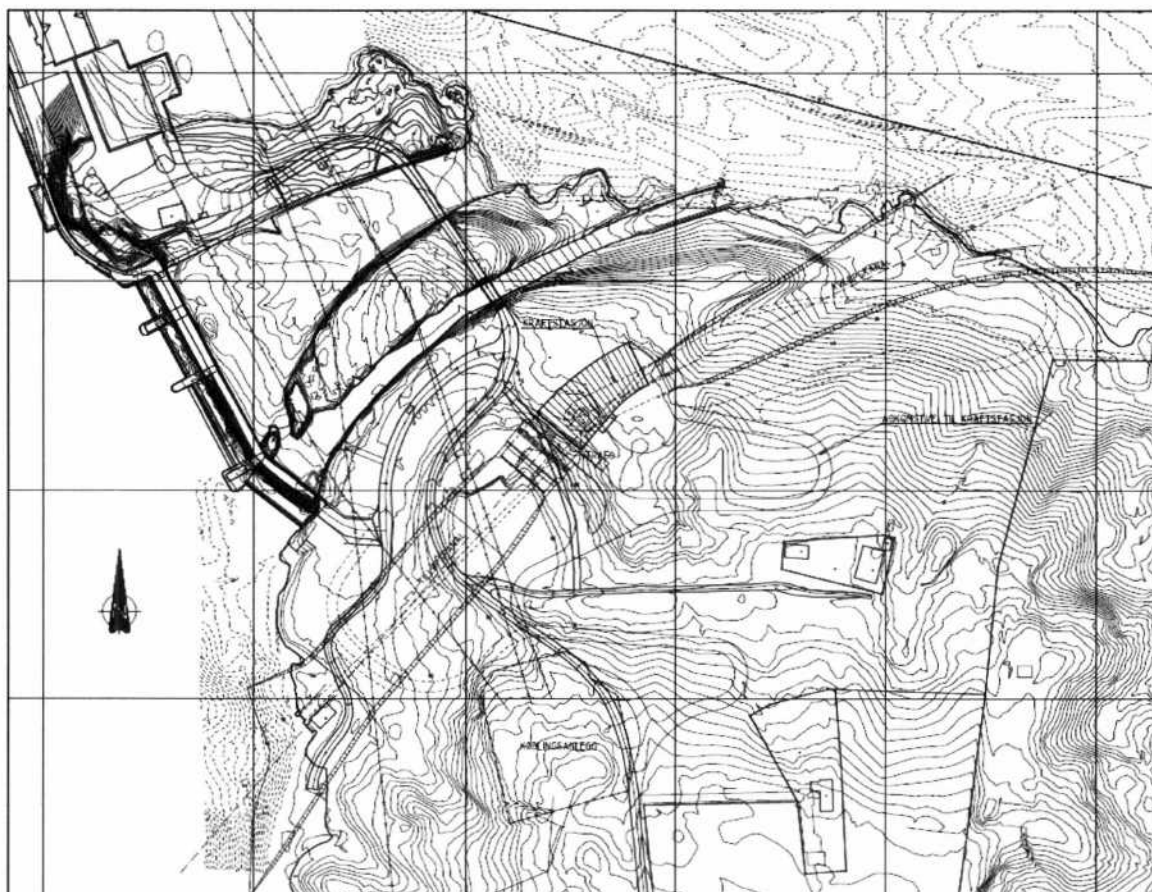
Figur 4 Vamma 12 med inntakskanal (nede til venstre), buet kraftstasjon og utløpskanal. Tegningen viser det største alternativet med slukeevne 550 m 3 /s. Anlegget ligger parallelt med flomløp og "tømmerrenne" Avstand mellom rasterlinjene er 100 m.
