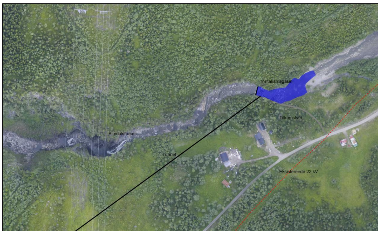
FIGUR 11: FLYFOTO MED INNTEGNET INNTAKSOMRÅDE FOR ALMDALSFOSSEN KRAFTVERK.
