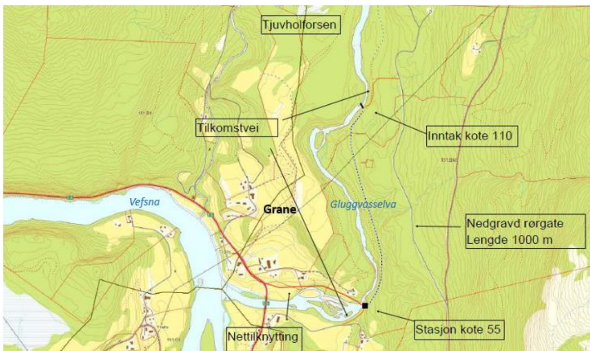
Figur 1. Kartet viser anleggsdetaljer for Tjuvholforsen kraftverk.
