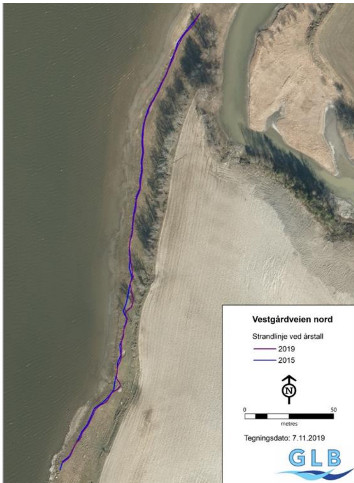
Figur 19 Ved Vestgårdveien-nord er det lav erosjonshastighet. Enkelte steder har skråningstoppen flyttet seg 2 – 3 meter innover mellom innmåling i 2015 og i 2019. Innmåling av strandlinja ble
