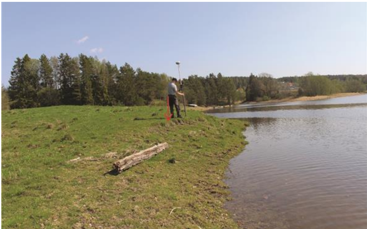
Figur 18 Ved Vestgårdveien sør ble toppen av skråningen målt inn, markert med rød pil. Det er lite vanndyp ved foten av skråningen og ikke tilstrekkelig sterke strømminger til å transportere alt erodert materiale bort. Dette bidrar til at skråningen over tid vil slakes ut.
