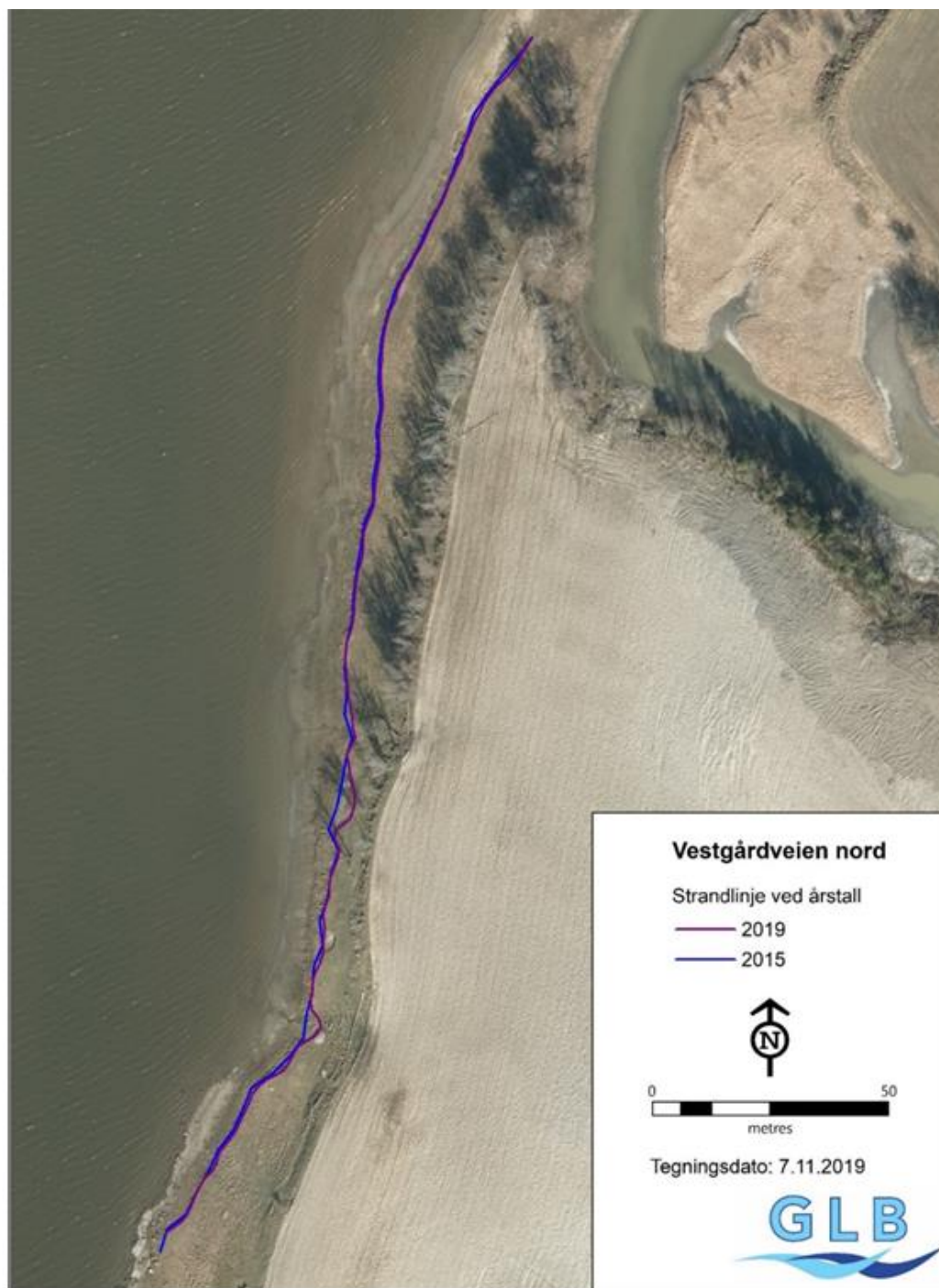
Figur 10 Ved Vestgårdveien-nord er det lav erosjonshastighet. Enkelte steder har skråningstoppen flyttet seg 2 – 3 meter innover mellom innmåling i 2015 og i 2019. Innmåling av strandlinja ble utført over en strekning på ca. 270 meter. Lav skråningshøyde, lite vanddyp i kombinasjon med begrenset strømningshastighet ved foten av skråningen bidrar til å begrense erosjonsutviklingen.
