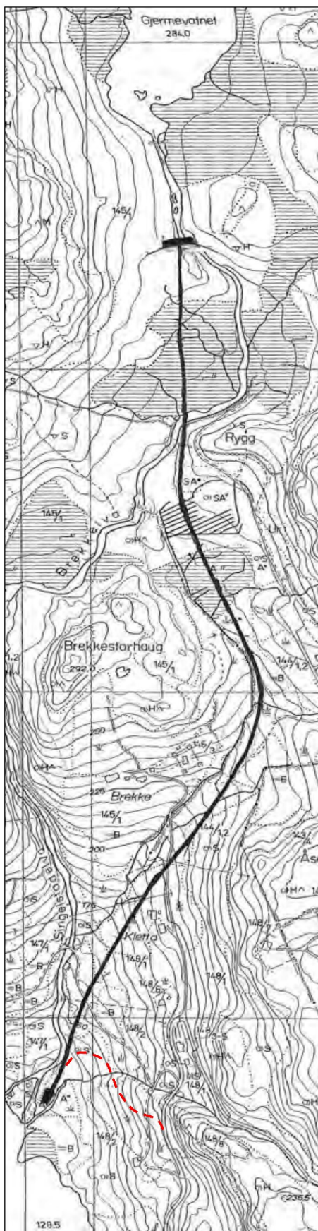
Fig. 6. Planlagt utbygging av et elvekraftverk i Brekkeelva med inntak, rørtrasé og kraftstasjon. Trase (ca) for ny vei til kraftstasjonen er vist i kartet med stiptet, rød linje. Kilde: Tiltakshaver.
