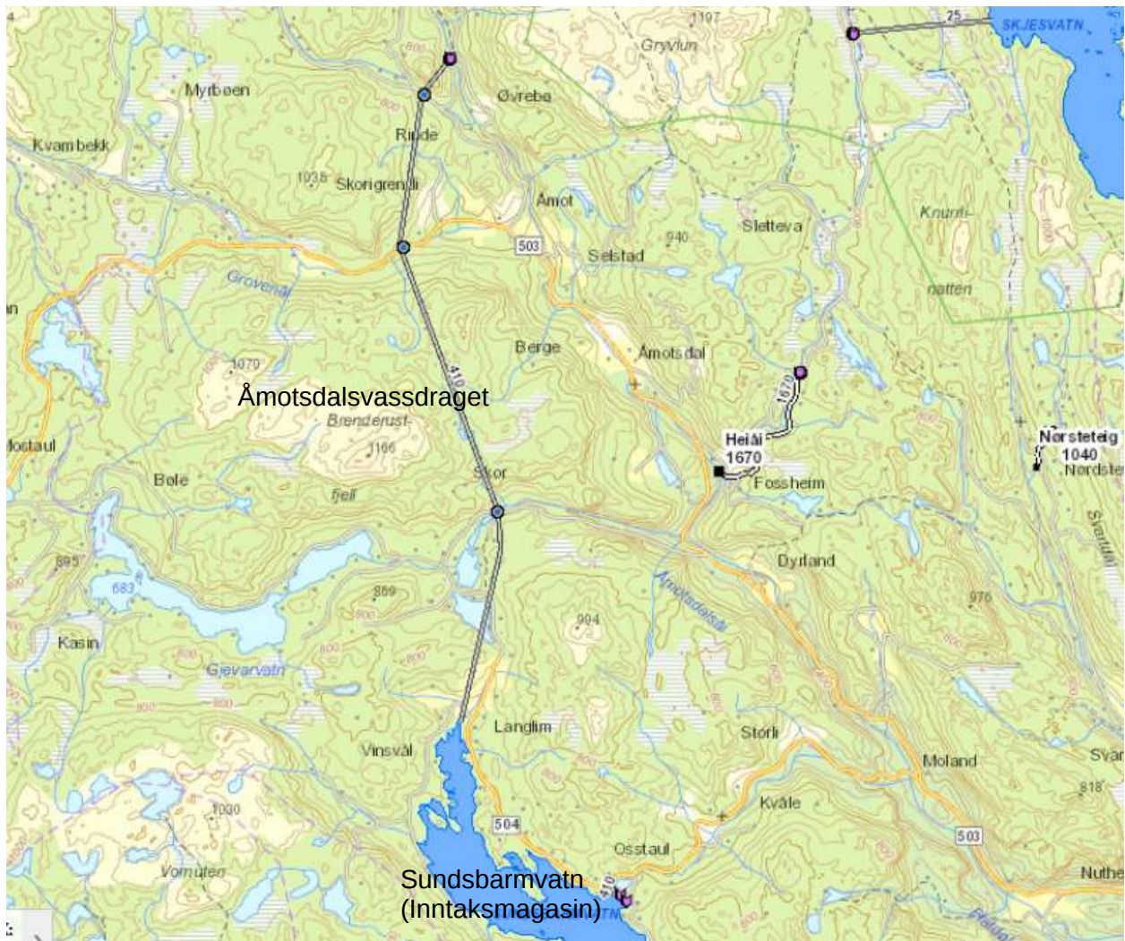
Figur 37: viser hvordan vannet fra Åmotsdalsvassdraget overføres via tunnelsystem til Sundsbarmvatn.
