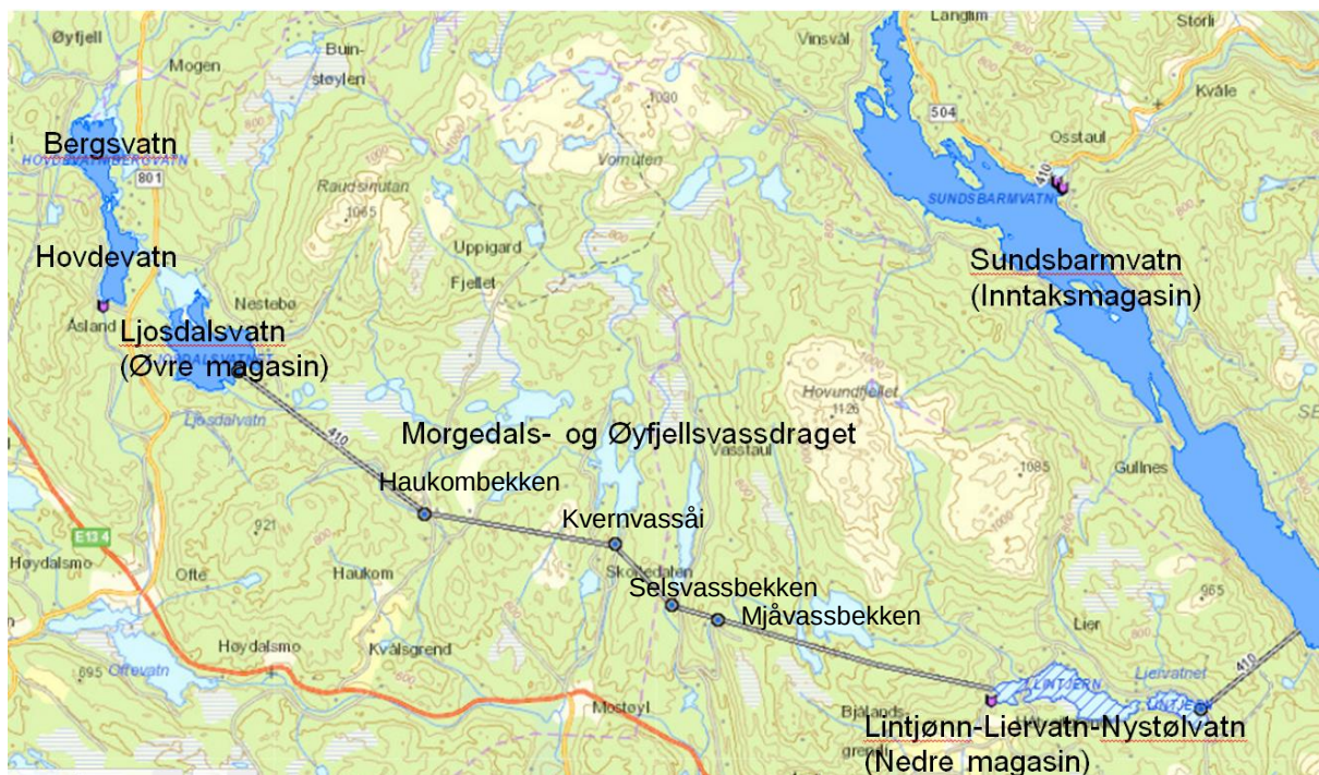
Figur 2 Kartskisse viser hvordan vannet fra Morgedals- og Øyfjellsvassdraget overføres via tunnelssystem til Sundsbarmvatn
