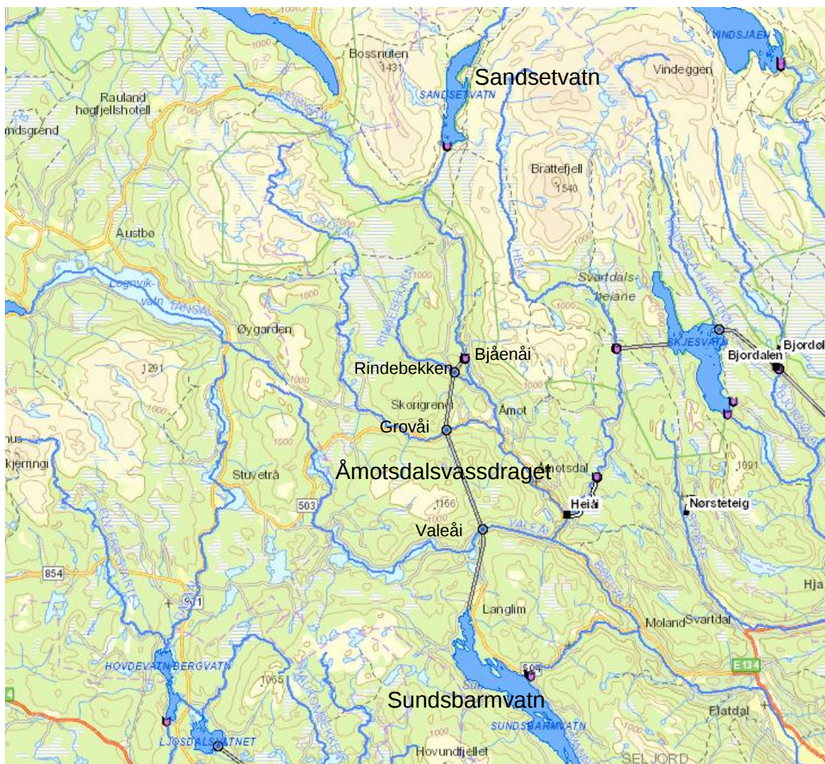
Figur 3 Kartskisse som viser hvordan vannet fra Sandsetvatn og Åmotsdalsvassdraget overføres via tunnelsystem til Sundsbarmvatn
