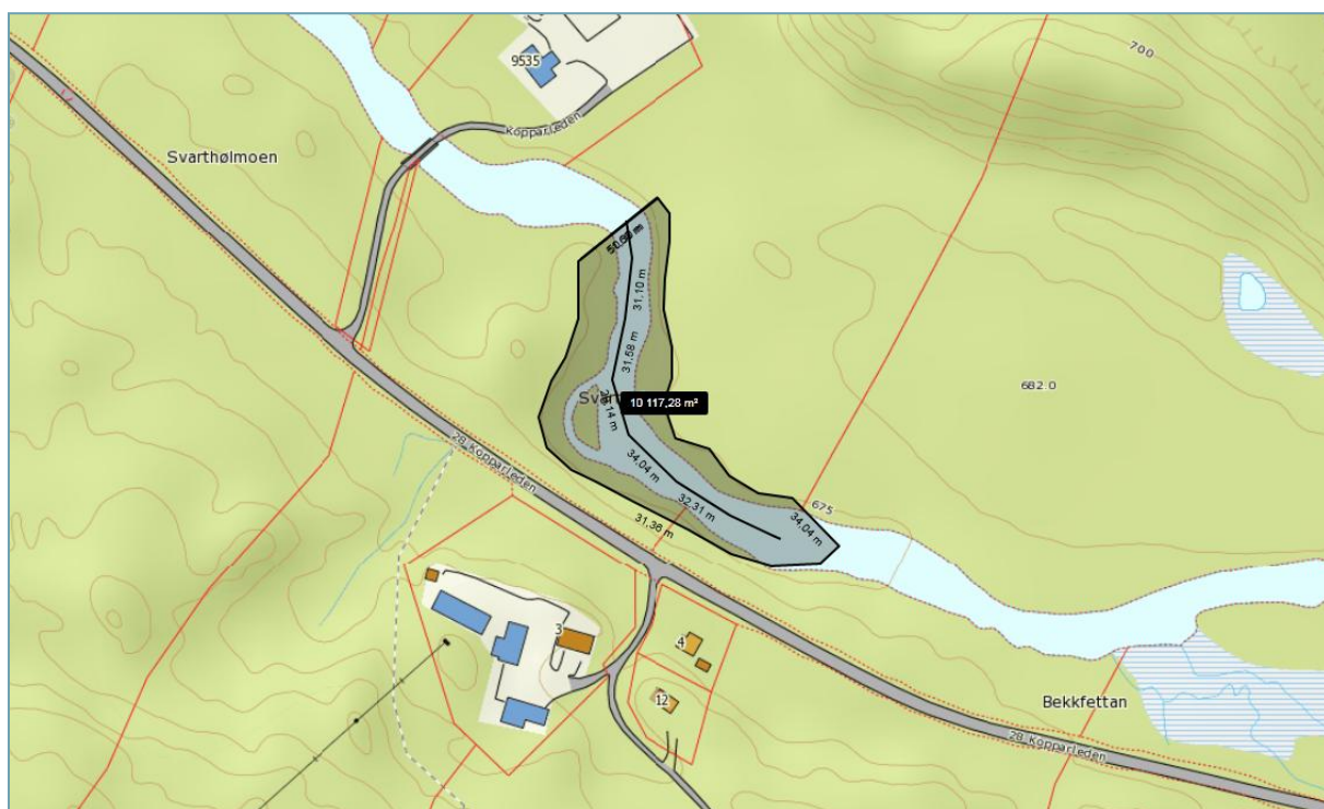
Fig. 9. Inntaksdammen vil strekke seg ca 200 meter oppover Nøra, basert på en damhøyde på 3 meter og ca 50 meters lengde. Samlet overflateareal ca 10 daa og volum ca 15 000 m 3 . Skytebanen ligger like NV for inntaksanlegget. Kartkilde: Gislink.
