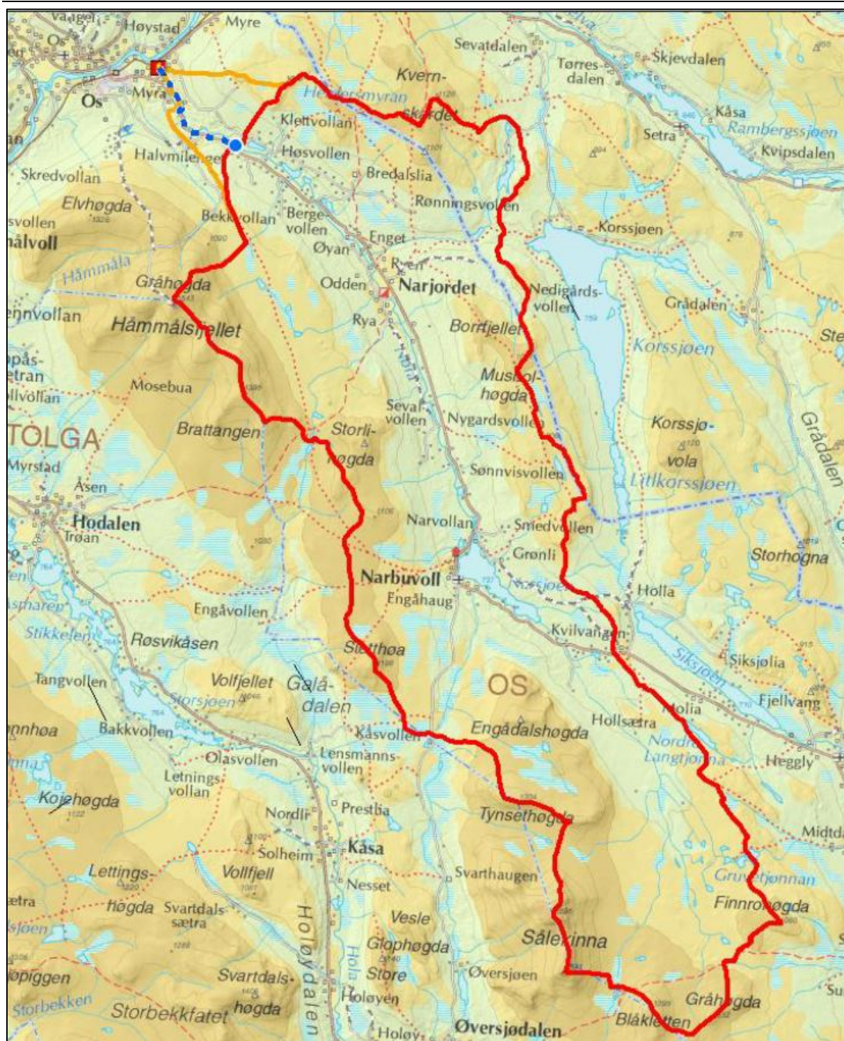
Fig. 5. Avgrensning av nedbørsfeltet knyttet til prosjektet ved Nøra. Narsjøen ligger sentralt i nedbørsfeltet. Nyttbart felt er beregnet til 246 km 2 . NVE-Regime nr.: 002.Q1A. Kilde: Blåfall AS.
