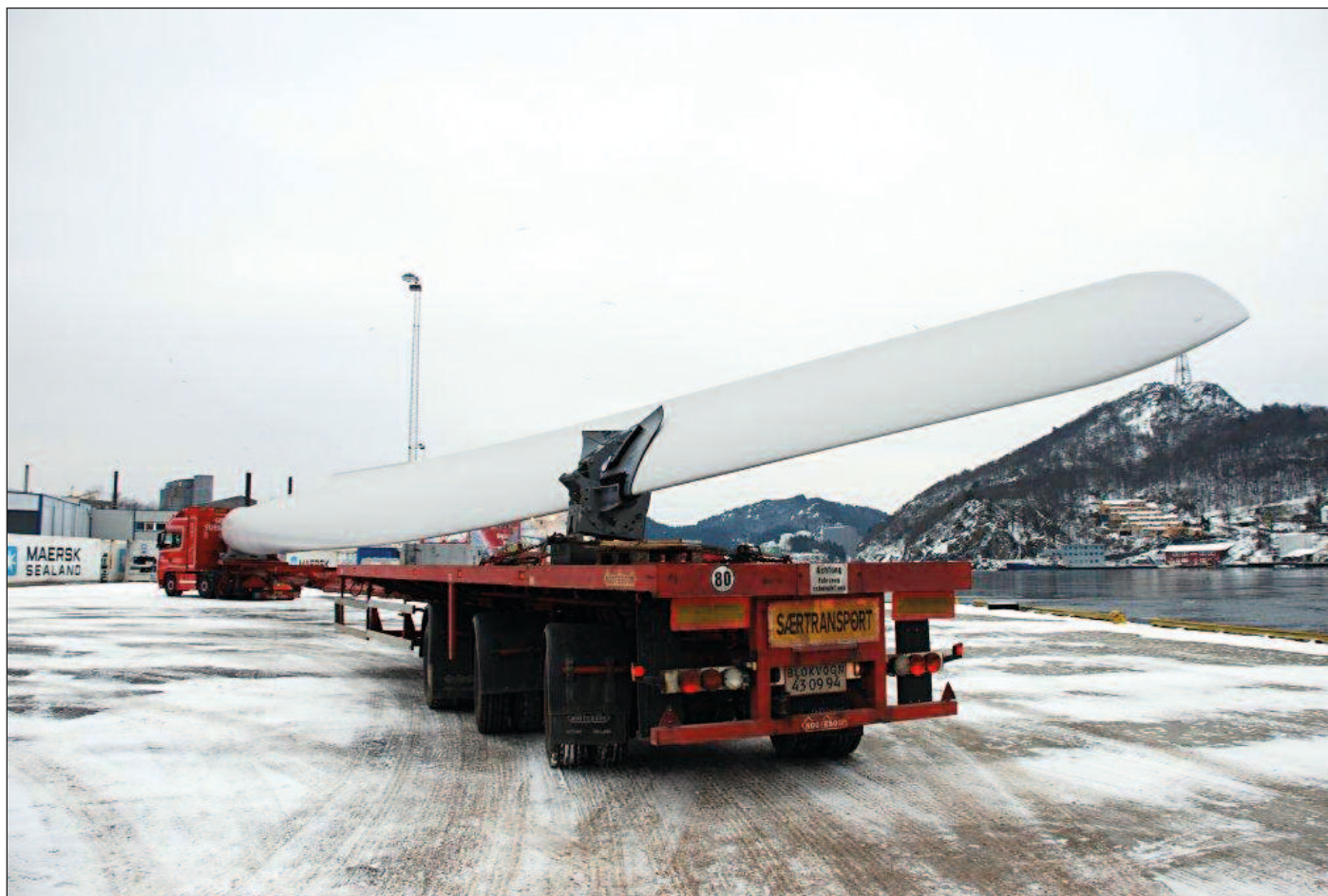
Bilde 3 Transport av turbinblad til Høg-Jæren vindpark. Bildet er tatt ved Egersund havn. Foto: Norsk Vind Energi AS.
