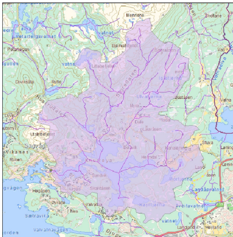
Figur 6. Storavatnet i Stord kommune med tilhørende nedbørfelt. Fra www.nve.no .
