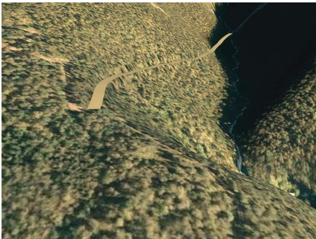
Bilde 10: Enkel visualisering av adkomstvei/rørgatetrasé til damsted
