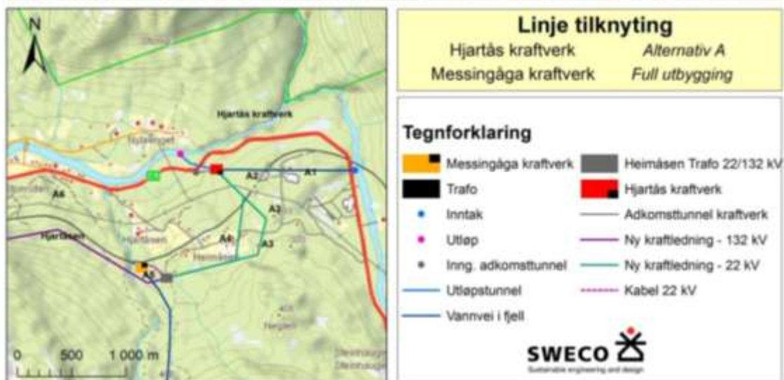
Figur 4-4. Planlagt kraftledning mellom Hjørtås kraftverk og Ørtfjellmoen transformatorstasjon. Utbygging etter alternativ A er vist.
