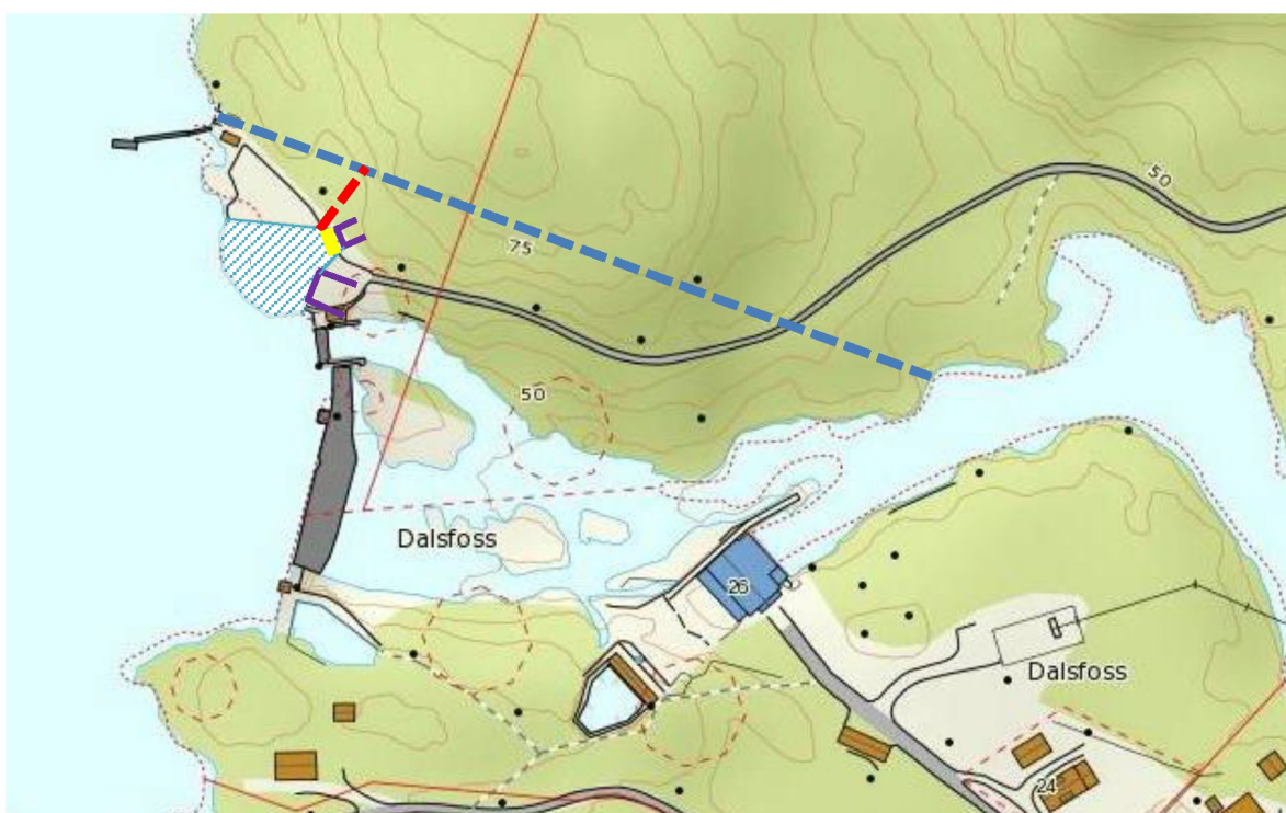
Figur 17. Kart over Dalsfoss med plassering av kulpetrapp skissert inn der tømmerrenna ligger (blå stiplet) og foreslått plassering av sideløp for smolt (rød stiplet) fra det nye inntaket til kulpetrappa i tunnelen. Varegrinda (gult) er skissert inn noe ut fra inntaket, for å redusere vannhastigheten inn mot varegrinda.
