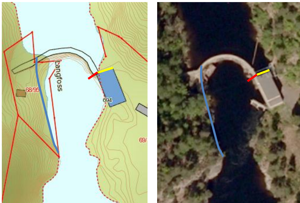
Figur 14. a) Kartutsnitt og b) flyfoto av Langfoss kraftverk med omtrentlig plassering av kulpetrapp (blå), varegrind (gul) og sideløp (rød).
