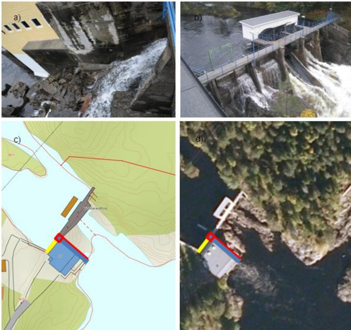
FIGUR 6: A) AKTUELL TRASÉ FOR LAKSETRAPP LANGS VEGGEN AV KRAFTVERKET, B) DEMNINGEN SETT OVENFRA, C) KARTUTSNITT OG D) FLYFOTO AV TVEITEREIDFOSS KRAFTVERK MED Plassering AV KULPETRAPP ELLER SPALTETRAPP (BLÅ), VAREGRIND (GUL) OG SIDELØP FOR SMOLTEN (RØD). (Kvingedal, E. M. FL. 2013).
