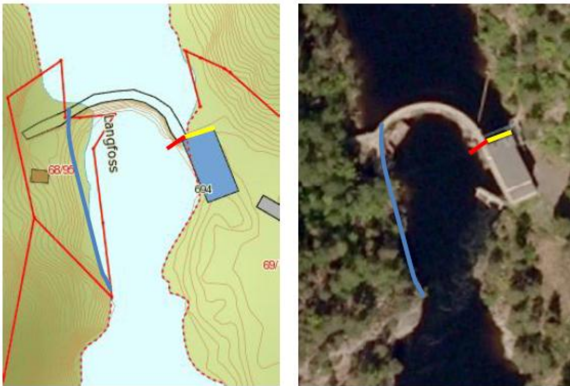
FIGUR 5: A) KARTUTSNITT OG B) FLYFOTO AV LANGFOSS KRAFTVERK MED OMTRENTLIG PLASSERING AV KULPETRAPP (BLÅ), VAREGRIND (GUL) OG SIDELØP (RØD). (KVIINGEDAL, E. M. FL. 2013).
