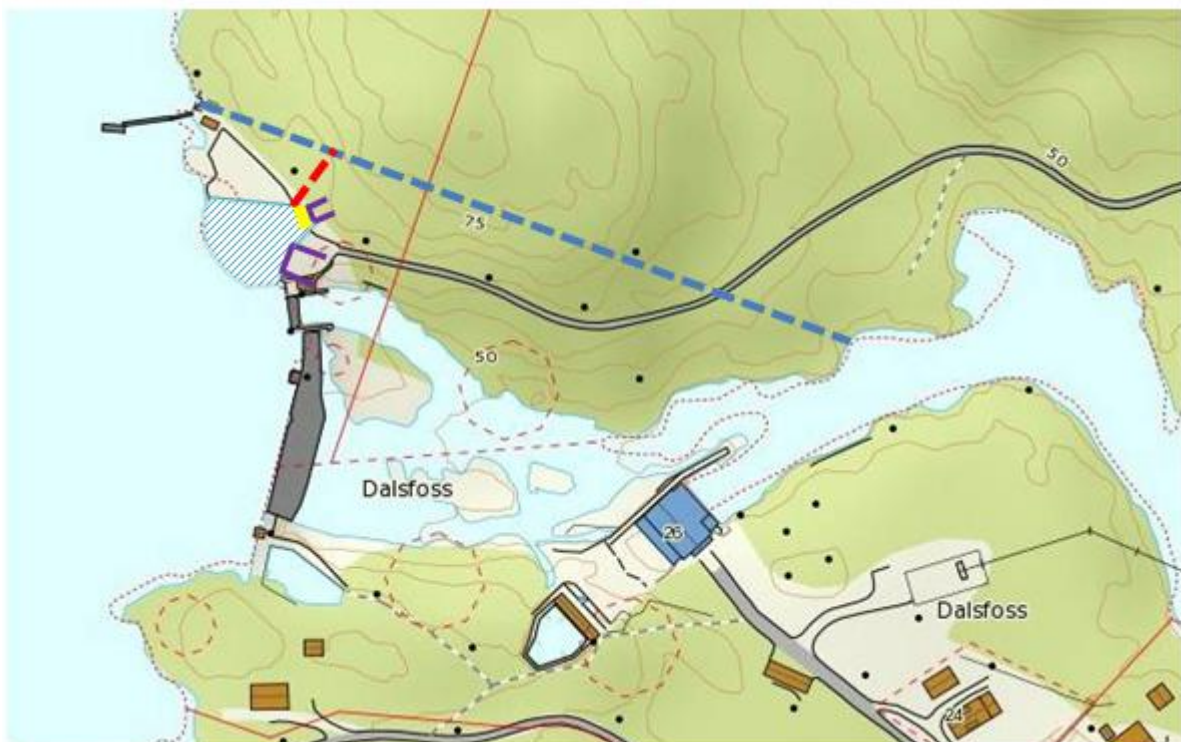
FIGUR 7: KART OVER DALSFLOSS MED Plassering av Kulpetrapp skissert inn der tømmerrenna ligger (blå stiplet) og foreslått plassering av sideløp for smolt (rød stiplet) fra det nye inntaket til kulpetrappa i tunnelen. Varegrinda (gult) er skissert inn noe ut fra inntaket, for å redusere vannhastigheten inn mot varegrinda. (Kvingedal, E. M. Fl. 2013).
