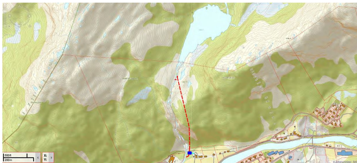
Figur 3. Kartutsnittet viser i grove trekk dei viktigaste naturinngrepa i form av dam, inntak, tunnel og kraftstasjon. Også avlaupskanalen og tilkomstvegen er teikna inn her. Kraftstasjonen er tenkt plassert om lag rett nedstraums Kvernhusfossen som også er rekna som absolutt vandringshinder for anadrom fisk i elva. Kartet er henta frå GisLink.
