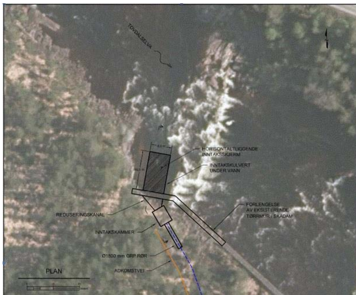
Figur 6: Plantegning av inntaket for Hauglandsfossen kraftverk
