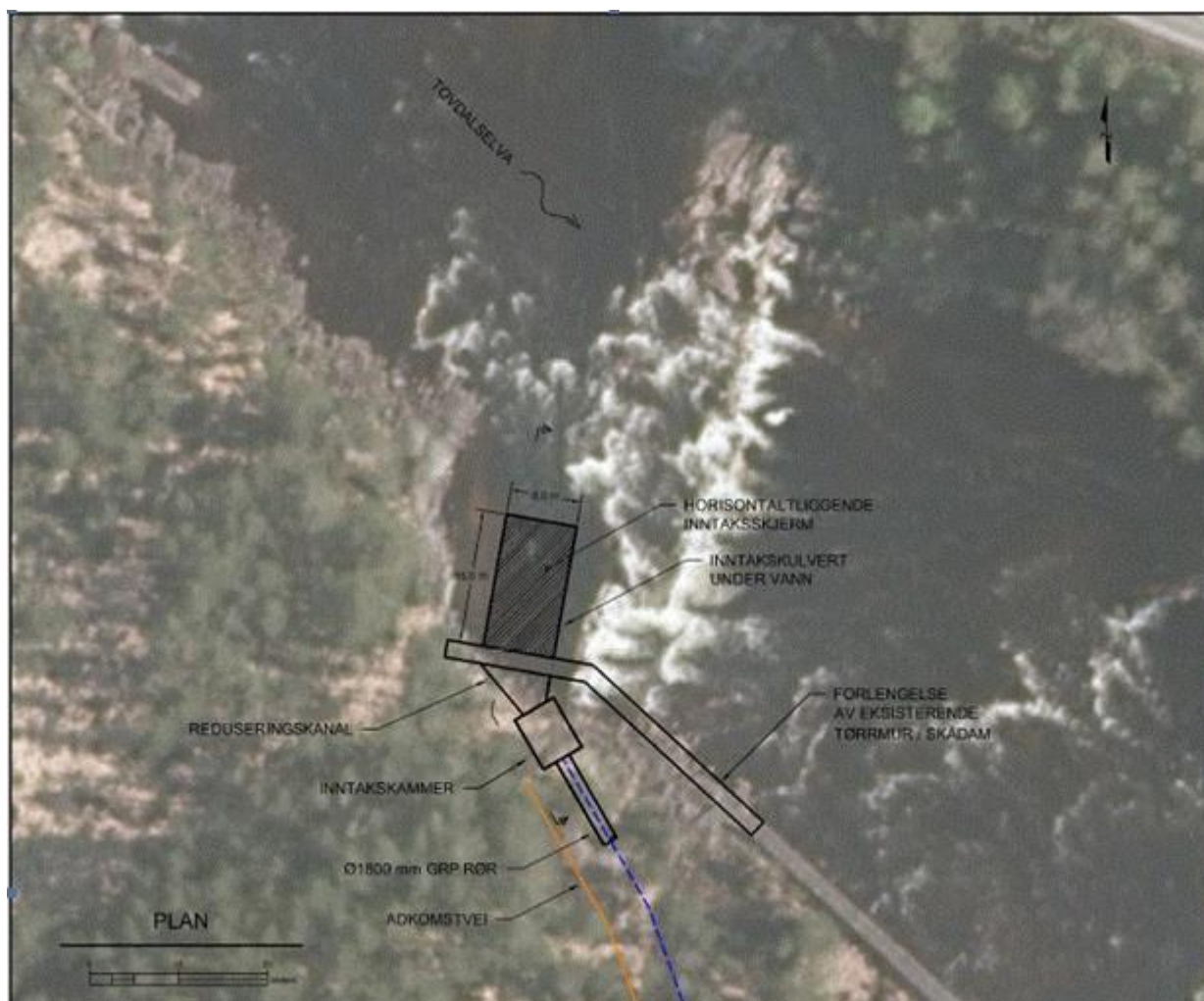
Figur 4. Planteikning for inntaket til Hauglandsfossen kraftverk.
