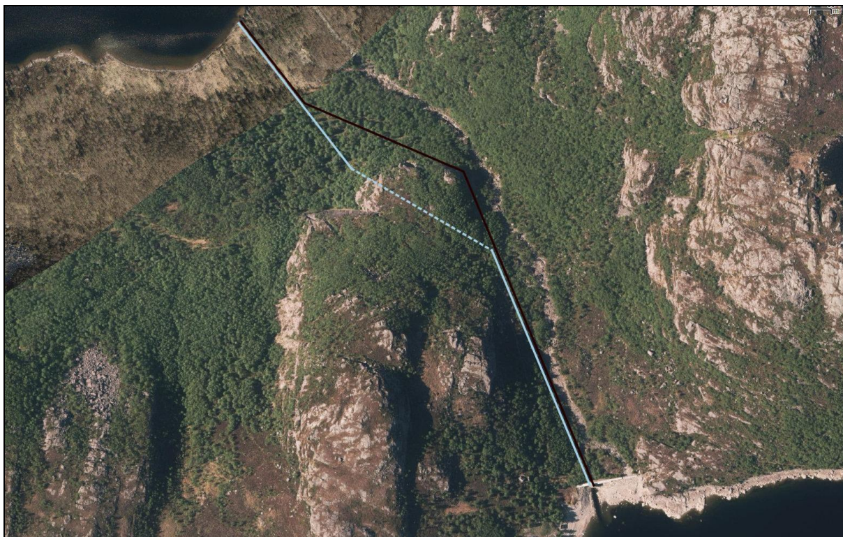
Figur 1. Ny rørgatetrasé er markert med svart linje, mens gammel trasé er markert med lys blå linje. Hel linje markerer nedgravd rørgate og stiplet linje markerer boret tunnel.
