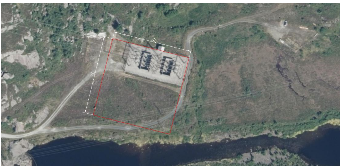
Figur 7 Dimensjonering av mulig fremtidig koblingsanlegg
